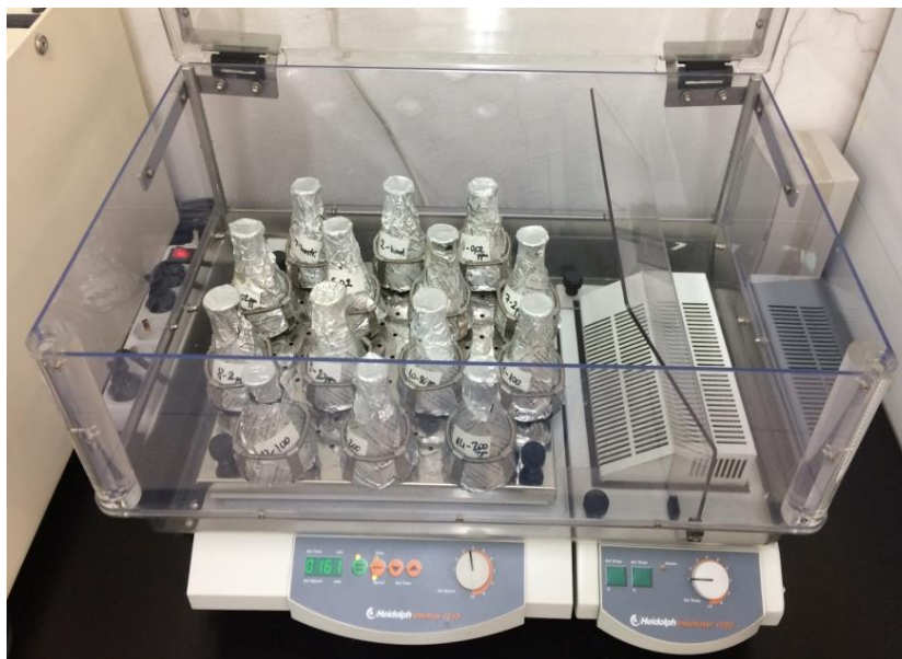
Slika 3.1. Provedba pokusa biorazgradnje na termostatiranoj rotacijskoj tresilici.
