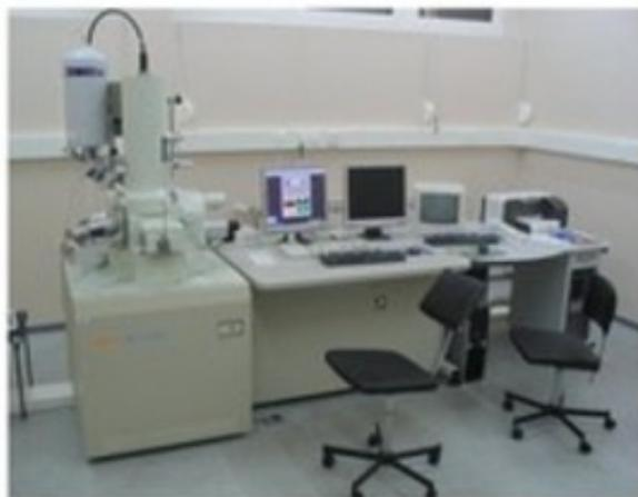
**Slika 3.7.** Pretražni elektronски микроскоп, JEOL (FE-SEM, model JSM-7000F
