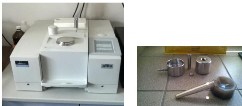
Slika 3.4. Ftir spektrofotometar, Spectrum One, Perkin Elmer, pribor za pripravu pastila
