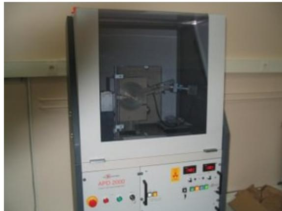
**Slika 3.6.** Difraktometar ItalStructures APD 2000
