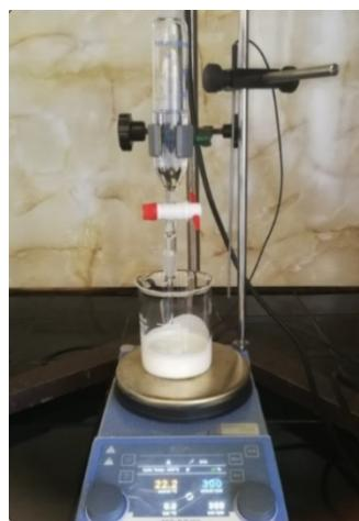
**Slika 3.2.** Aparatura za sintezu titanijeva (IV) oksida ( $\text{TiO}_2$ )
