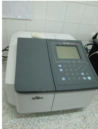
**Slika 12. Spektrofotometar**
