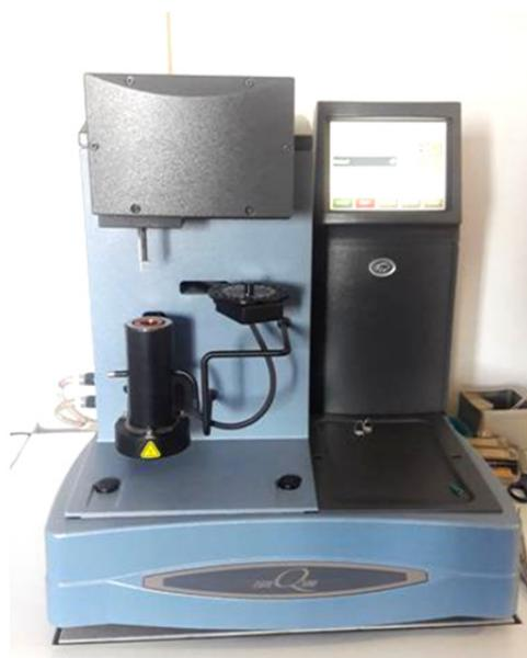
*Slika 31.* TGA uređaj tvrtke *TA Instruments*
