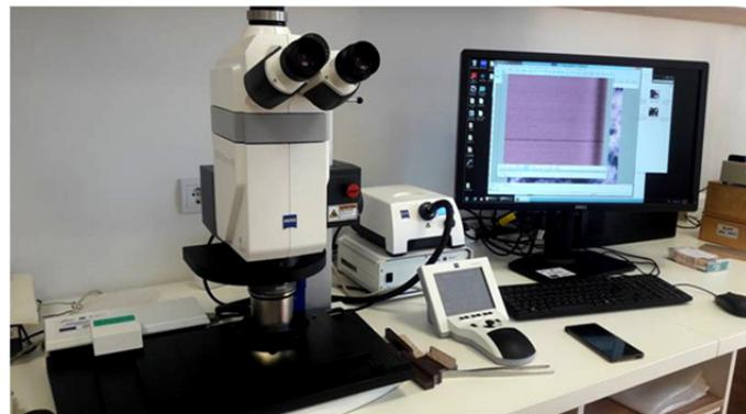
*Slika 34.* Optički mikroskop Axio Zoom V16
