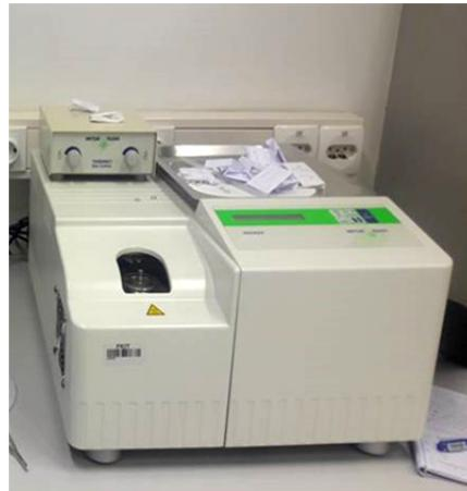
*Slika 30.* Diferencijali pretražni kalorimetar Mettler toledo DSC 823e
