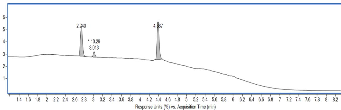
**Slika 4.11.** Kromatogram lidokaina tretiranog s 30%  $\text{H}_2\text{O}_2$
