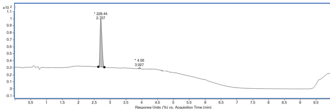
**Slika 4.12.** Kromatogram lidokaina tretiranog s 1 M  $\text{HCl}$
