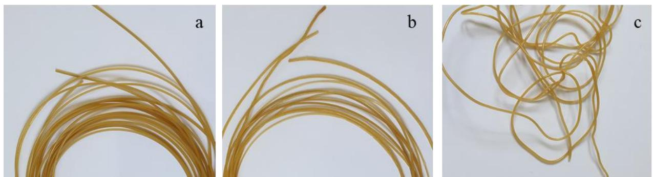
**Slika 17.** Dobiveni filamenti: a) PVA TO 10% 150, b) PVA TO 10% 160,
