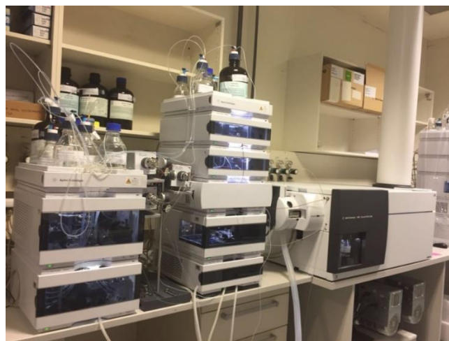
Slika 6. Tekućinski kromatograf ultravisoke djelotvornosti povezan sa spektrometrom masa visoke razlučivosti (2D-UHPLC-QTOF)
