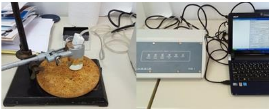
Slika 3.2.7.1. Aparatura za mjerenje toplinske vodljivosti
