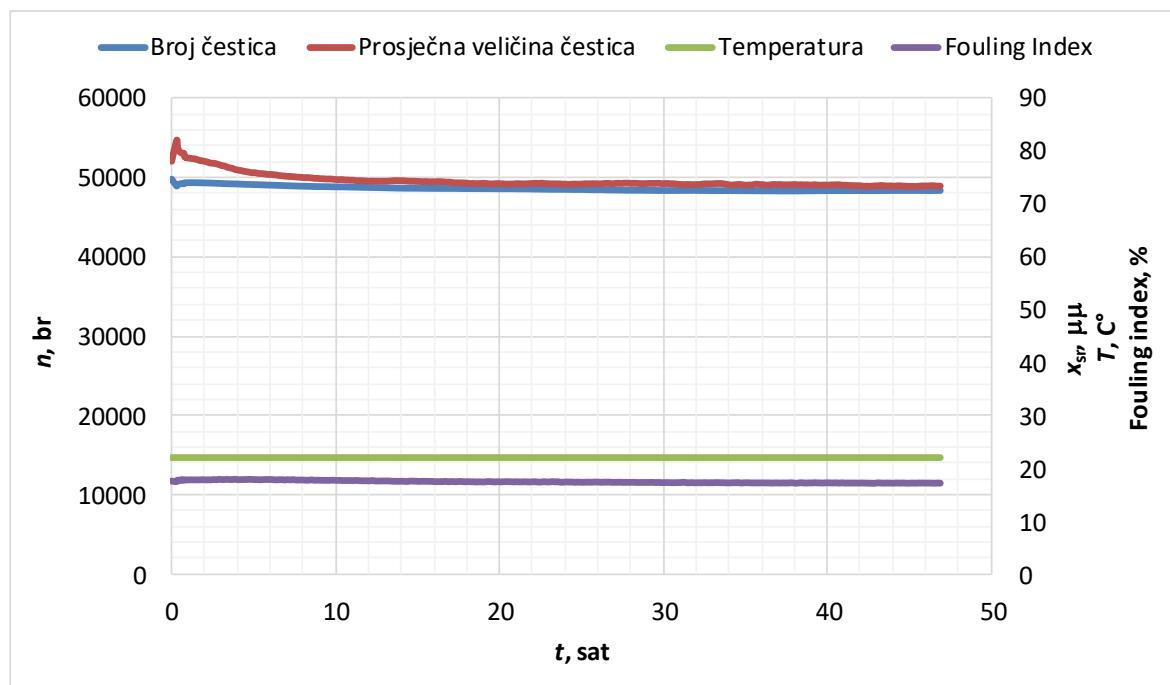
Slika 4-3-3-3 *In-line* praćenje procesa priprave polimorfa A iz eksperimenta OMP A-3 FBRM uređajem
