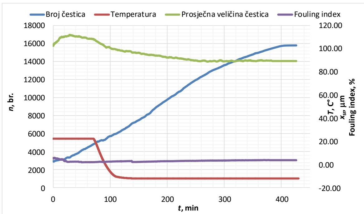
Slika 4-3-3-11 *In-line* praćenje procesa pripreme polimorfa C iz eksperimenta OMP C-3 FBRM uređajem
