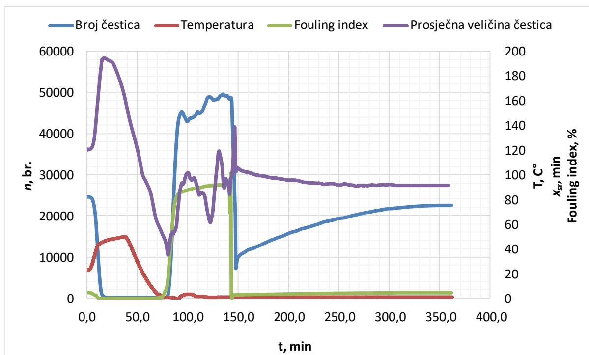
Slika 4-3-3-7 *In-line* praćenje procesa priprave polimorfa B iz eksperimenta OMP B-3 FBRM uređajem
