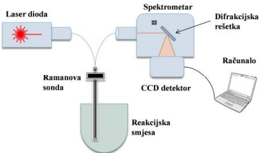
Slika 2-4-4-1 Shematski prikaz mjerjenja disperzivnom Ramanovom spektroskopijom *in-line*
