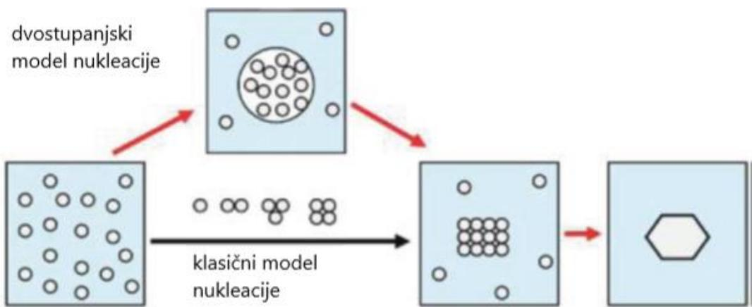
Slika 1-2-1 Shematski prikaz modela dvostupanjske nukleacije
