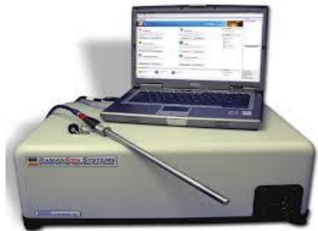
Slika 3-3-2 Raman uređaj za spektroskopiju *RAMANRXN SYSTEMS*
