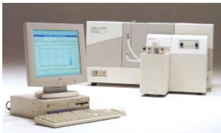
Slika 3-3-6 Čestični analizator Shimadzu SALD-3101
