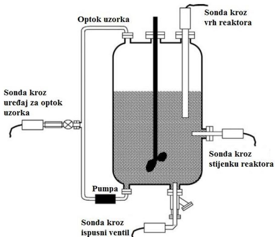
Slika 1-4-2-1 Shematski prikaz principa *in-line* i *on-line*<sup>43</sup>
