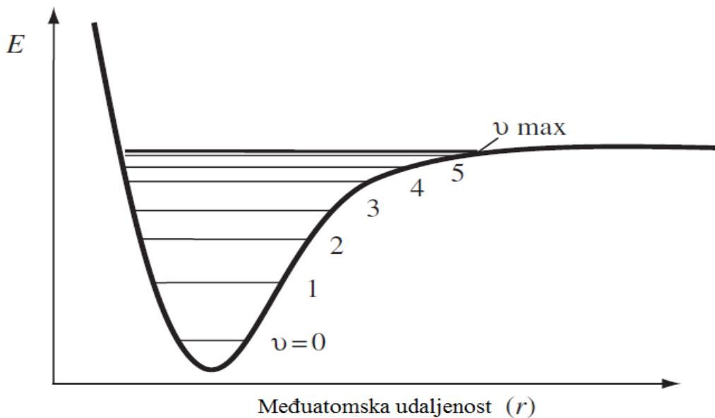
Slika 1-4-3-1 Morseova krivulja ovisnosti energije o međuatomskoj udaljenosti u molekuli<sup>45</sup>
