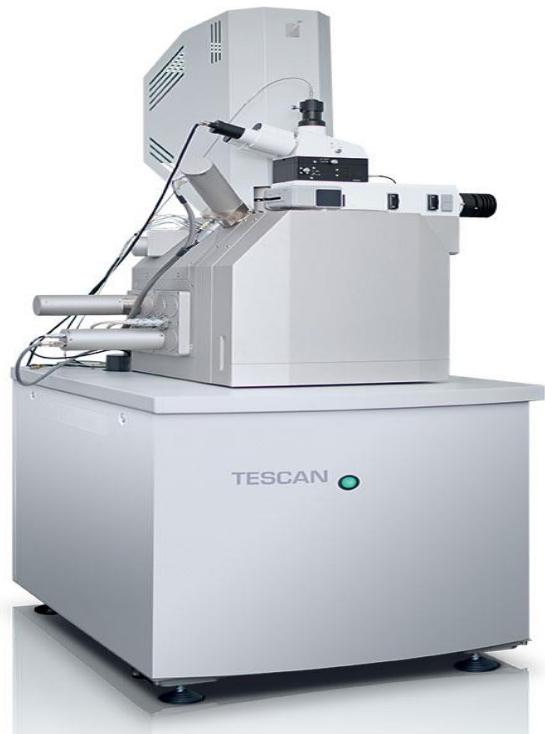
Slika 3-3-4 Pretražni elektronski mikroskop *Tescan Vega III Easypow*
