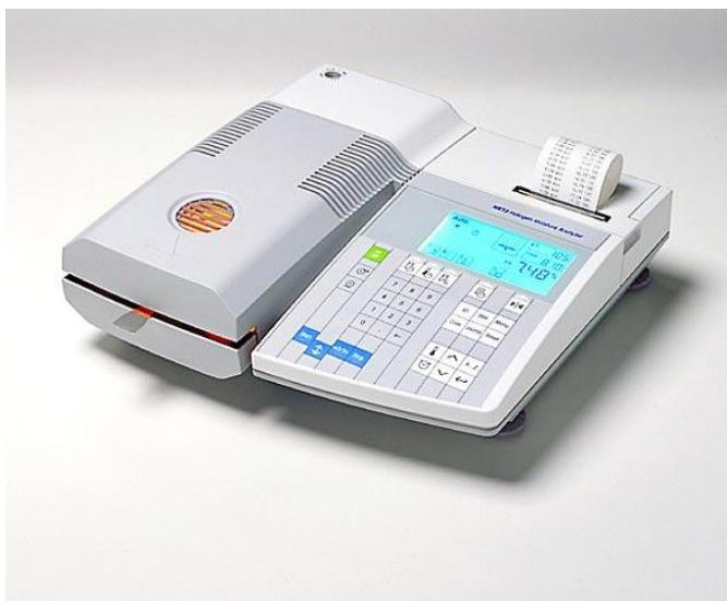
Slika 3-3-1 Vlagomjer *HR73 Halogen Moisture Analyzer*
