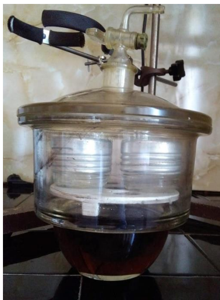
Slika 3.3.5.1: Aparatura za ispitivanje propusnosti vodene pare
