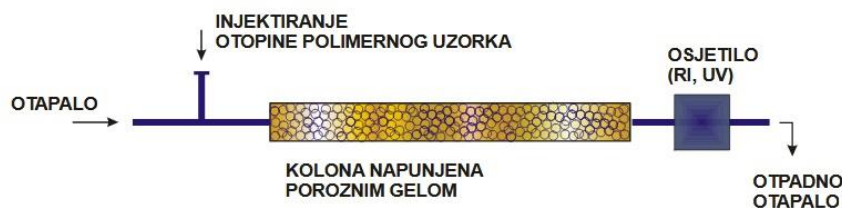
Slika 2.5.1. Shema rada GPC uređaja
