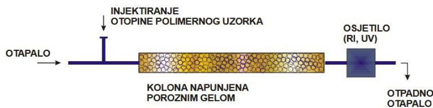
Slika 2.5.1. Shema rada GPC uređaja
