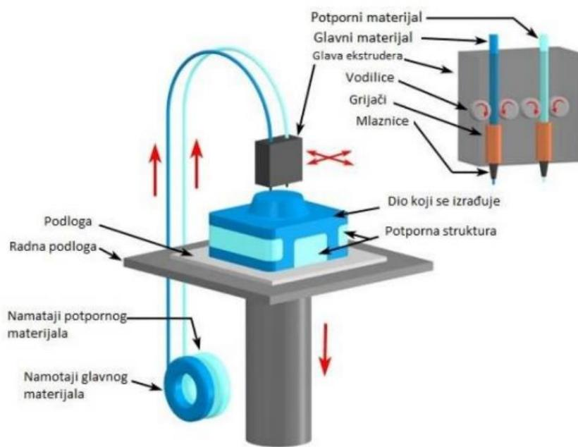
Slika 8. Izrada modela postupkom taložnog srašćivanja [22]
