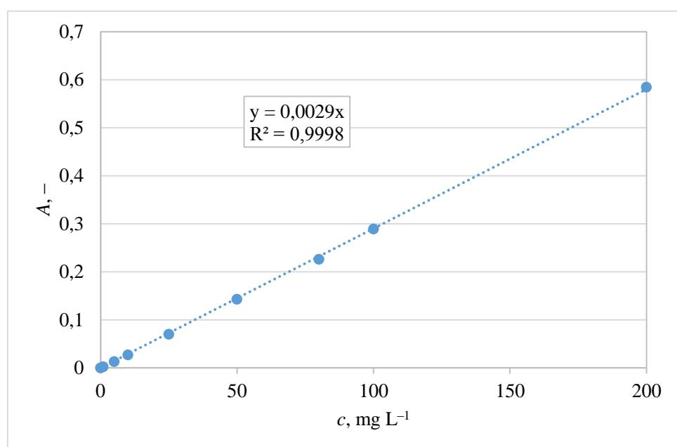
Slika 26. Umjerni pravac dronedarona u fosfatnom puferu
