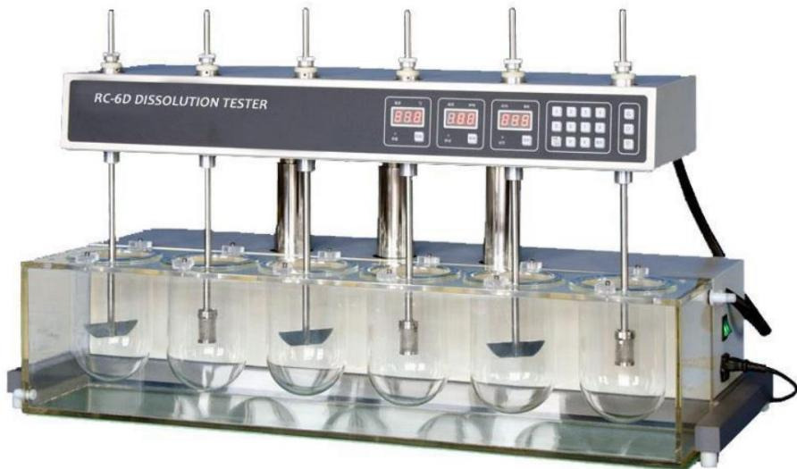
**Slika 23.** Uređaj za ispitivanje otpuštanja djelatnih tvari (RC-6D, Zhengzhou Nanbei Instrument)
