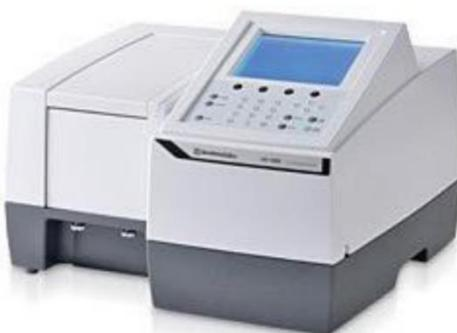
Slika 25. UV/Vis spektrofotometar (UV-1280, Shimadzu)
