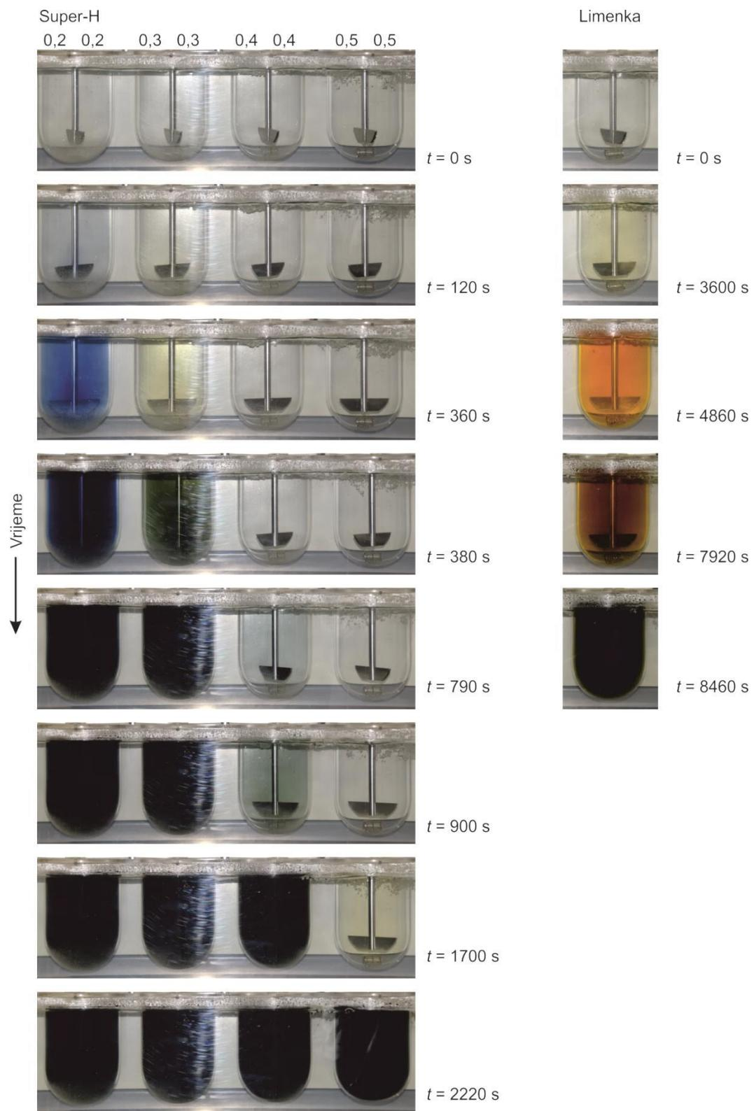
**Slika 30.** Prikaz fotografija ispitivanja oslobođanja bojila iz kapsula u 0,1 M HCl
