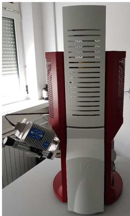
Slika 3.9. Pretražni elektronski mikroskop TESCAN Mira3
