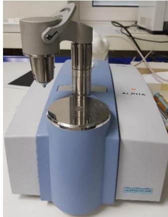
Slika 3.8. Infracrveni spektrometar Bruker
