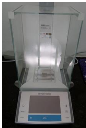
Slika 3.1. Analitička vaga Mettler Toledo XA105DU
