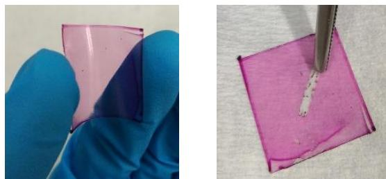
**Slika 4.5:** Mehaničke karakteristike tankoslojnih filmova; savitljivost i otpornost
