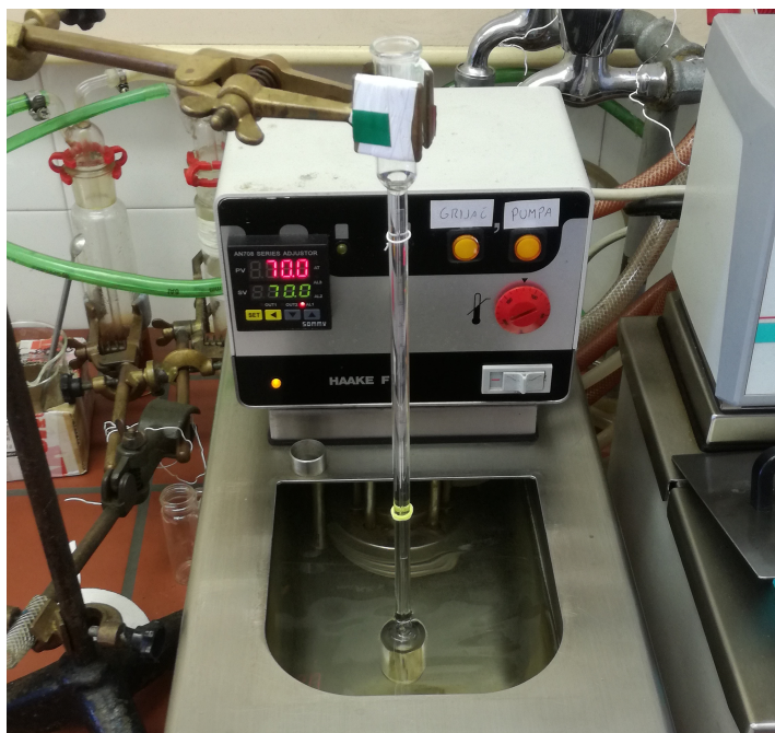
Slika 19 – Dilatometar grijan u uljnoj kupelji.
