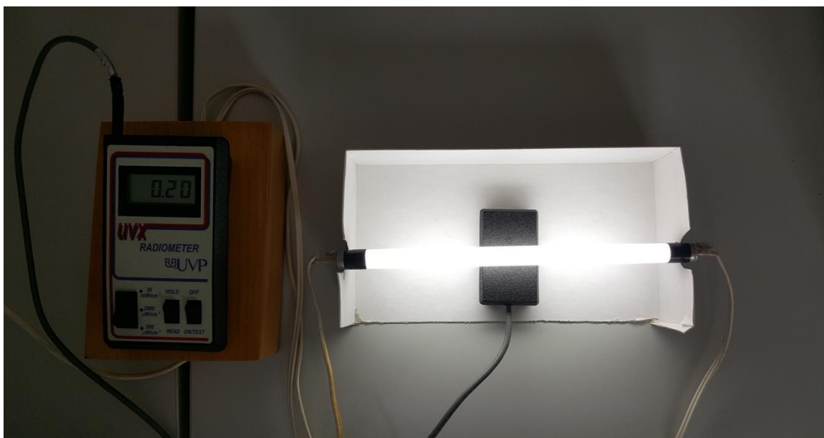
Slika 3.4. Mjerenje intenziteta zračenja
