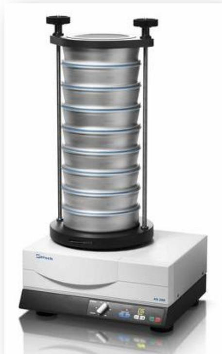
**Slika 3.8.** Uredaj za potresivanje Retsch AS 200
