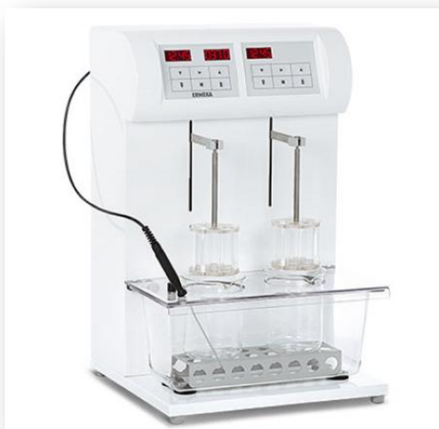
Slika 3.16. Fotografija uređaja za ispitivanje raspadljivosti tableta ZT 322 (Erweka GmbH, Langen, SR Njemačka).
