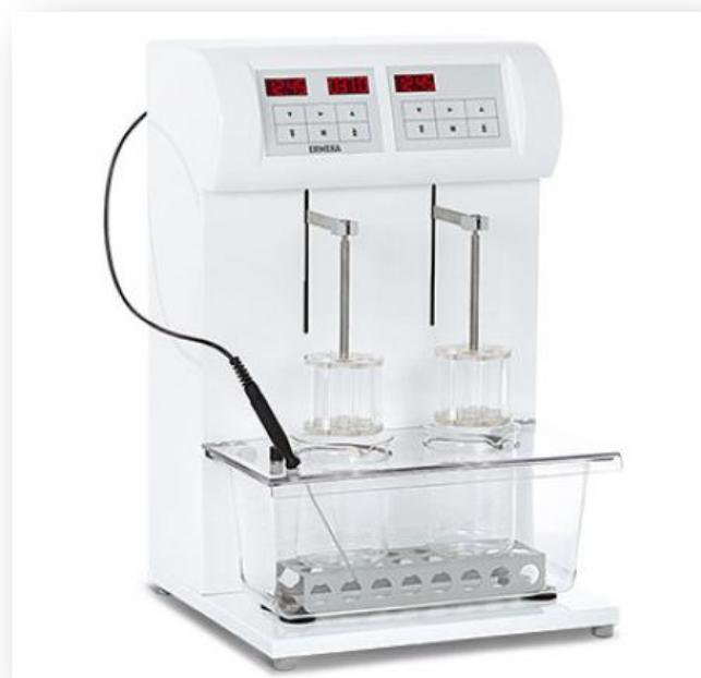
**Slika 3.16.** Fotografija uređaja za ispitivanje raspadljivosti tableta ZT 322
