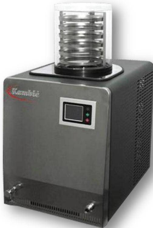
**Slika 3.6.** Fotografija liofilizatora LIO-5 PLT
