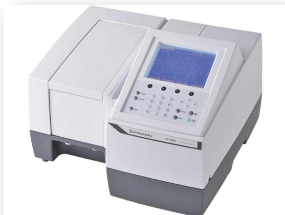
**Slika 3.17.** Fotografija spektrofotometra UV-1280 (Shimadzu, Kyoto, Japan).
