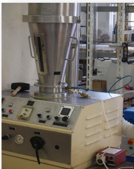
Slika 3.7. Fotografija granulatora s fluidiziranim slojem Uni-Glatt (Glatt GmbH, Binzen, SR Njemačka).
