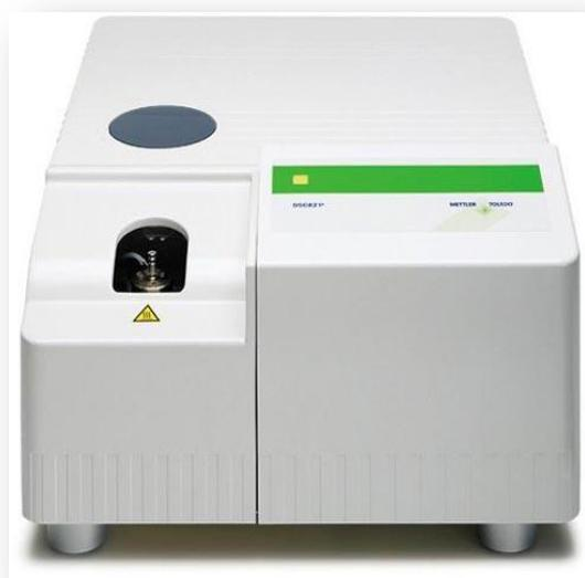
**Slika 3.13.** Fotografija diferencijalnog pretražnog kalorimetra Mettler Toledo 822<sup>e</sup> (Mettler Toledo GmbH, Greifensee, Švicarska).
