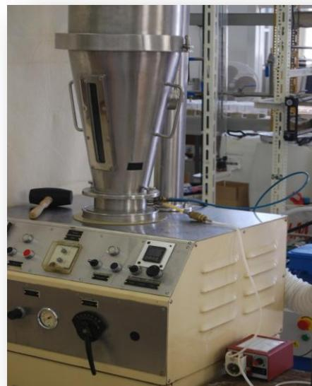
**Slika 3.7.** Fotografija granulatora s fluidiziranim slojem Uni-Glatt (Glatt GmbH, Binzen, SR Njemačka).
