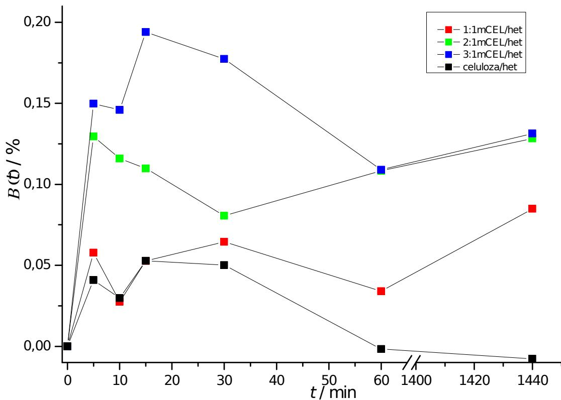
Slika 31. Ravnotežna vrijednost apsorbiranog dieselskog goriva ( $\alpha$ ) u ovisnosti o vremenu u sustavu  $w(\text{dieselsko gorivo}) : w(\text{voda}) = 0,8:0,2$  za uzorke 1:1/mCEL/het, 2:1/mCEL/het, 3:1/mCEL/het i celulozu
