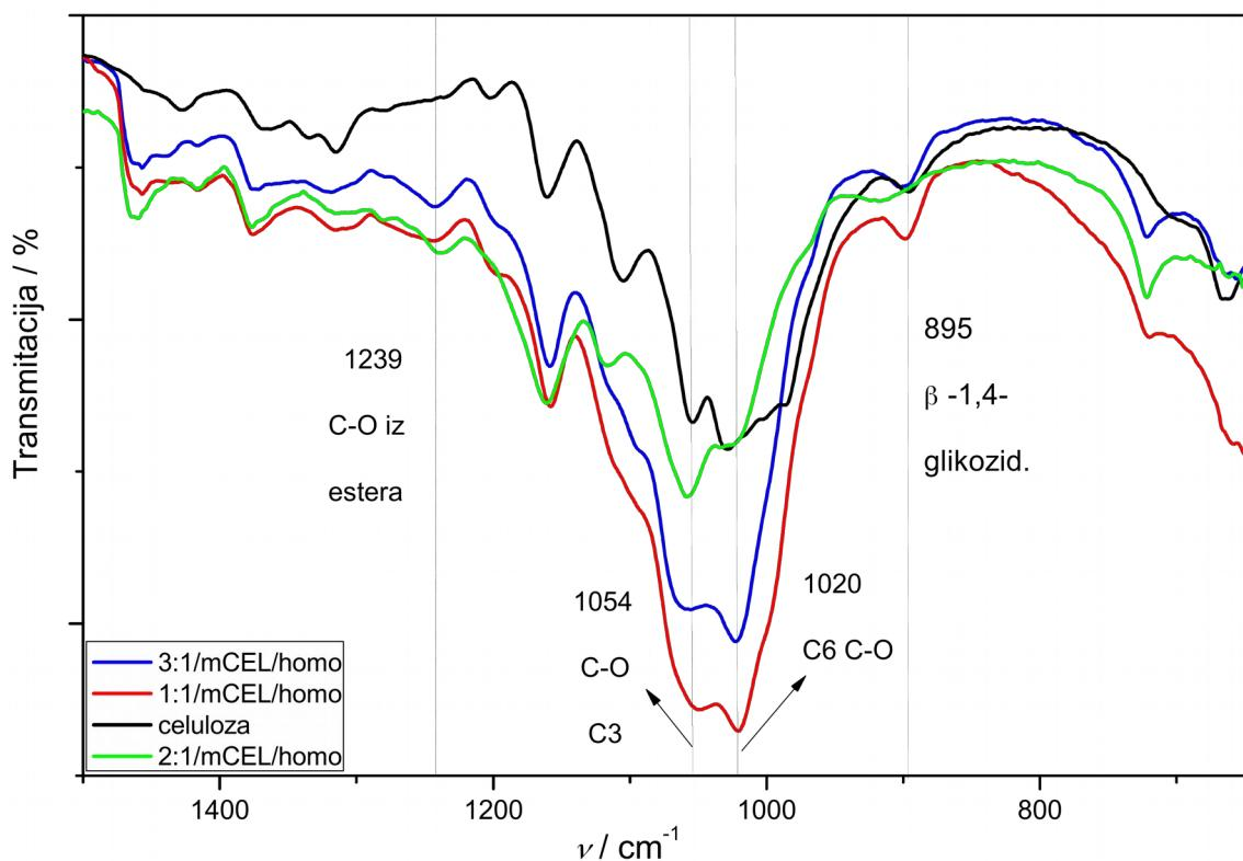
Slika 14. Uvećana usporedba rezultata FTIR analize uzoraka  $1:1/\text{mCEL/homo}$ ,  $2:1/\text{mCEL/homo}$  te  $3:1/\text{mCEL/homo}$ , dobivenih u homogenim uvjetima, dio spektra valnih brojeva raspona  $2100\text{-}700 \text{ cm}^{-1}$
