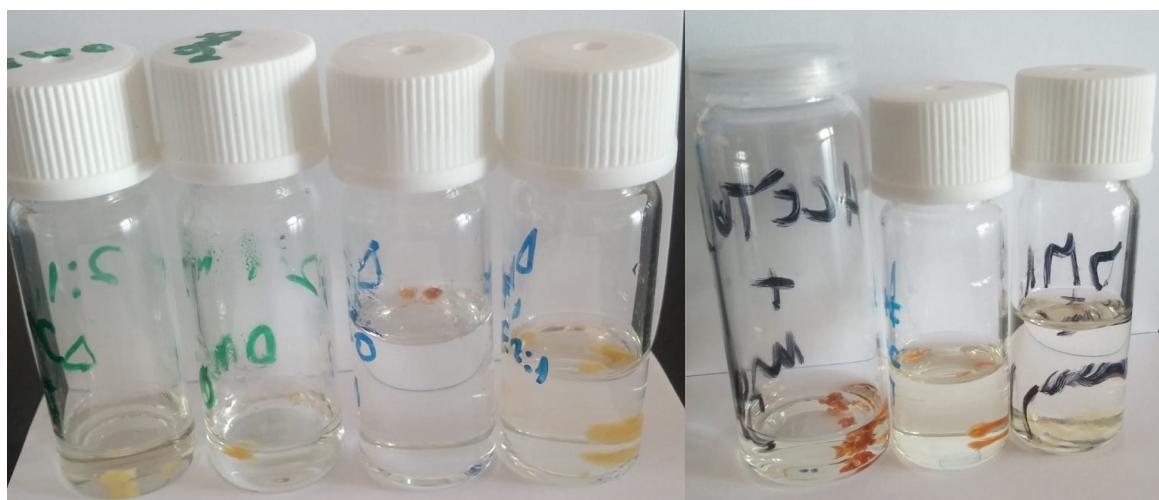
Slika 11. Uzorak s omjerom reaktanata  $n(\text{-OH})_{\text{celuloze}} : n(\text{klorid oleinske kiseline}) = 2:1$  u dimetilacetamidu, dimetilsulfoksidu, kloroformu i dimetilformamidu (lijevo) te celuloze  $n(\text{-OH})_{\text{celuloze}} : n(\text{klorid oleinske kiseline}) = 1:1$  u acetonu, toluenu i dimetilformamidu (desno)
