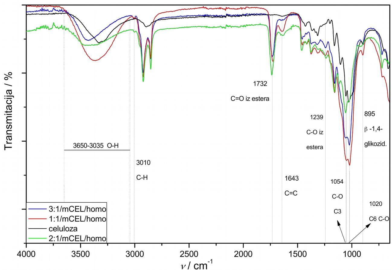
Slika 13. Usporedba rezultata FTIR analize uzoraka  $1:1/\text{mCEL/homo}$ ,  $2:1/\text{mCEL/homo}$  te  $3:1/\text{mCEL/homo}$ , dobivenih u homogenim uvjetima
