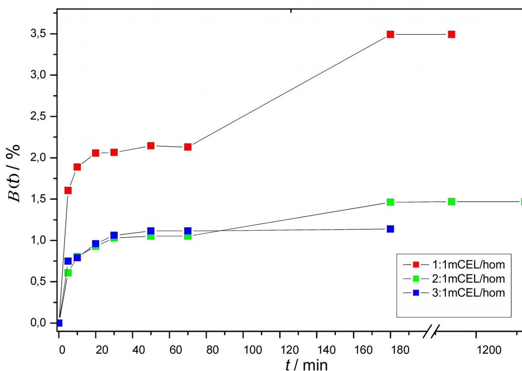
Slika 25. Bubrenje funkcionalizirane celuloze u sustavu DMAc/LiCl
