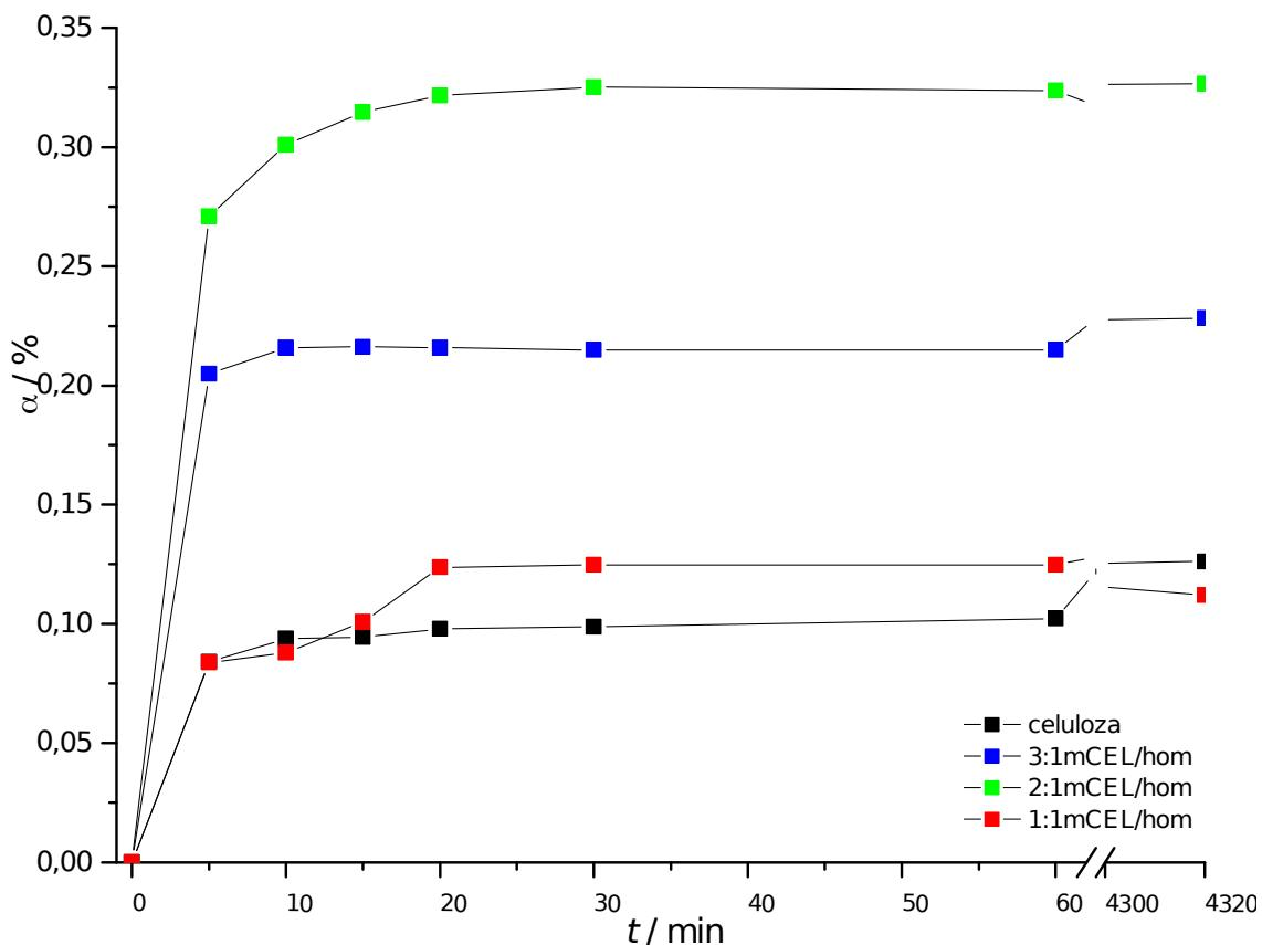
Slika 30. Ravnotežna vrijednost apsorbiranog dieselskog goriva ( $\alpha$ ) u ovisnosti o vremenu u sustavu  $w(\text{dieselsko gorivo}) : w(\text{voda})$  :  $w(\text{voda}) = 0,2:0,8$  za uzorke  $1:1/mCEL/hom$ ,  $2:1/mCEL/hom$ ,  $3:1/mCEL/hom$  i celulozu
