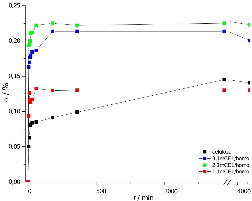
Slika 29. Ravnotežna vrijednost apsorbiranog dieselskog goriva ( $\alpha$ ) u ovisnosti o vremenu u sustavu  $w(\text{dieselsko gorivo}) : w(\text{voda}) = 0,8:0,2$  za čistu celulozu te uzorke  $1:1/mCEL/homo$ ,  $2:1/mCEL/homo$  te  $3:1/mCEL/homo$
