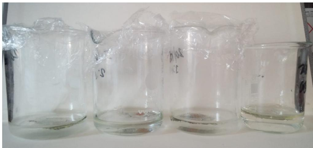
Slika 28. Uzorci s lijeva na desno  $1:1/mCEL/hom$ ,  $2:1/mCEL/hom$  te  $3:1/mCEL/hom$  i celuloza (desno) u metalnim mrežastim nosačima tijekom ispitivanja asorpcije u suspenziji dieselskog goriva i vode,  $w(\text{dieselsko gorivo}) : w(\text{voda}) = 0,2:0,8$
