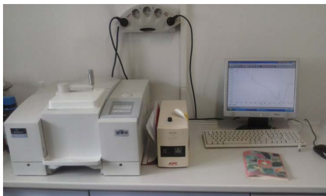
Slika 3.6. FT-IR spektrofotometar Perkon Elmer Instruments, Spectrum One, povezan s računalom
