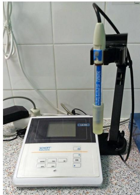
**Slika 7.** pH metar *LAB 860 Schott*
