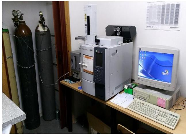
**Slika 9.** Plinski kromatograf *Shimadzu GC – 2014*
