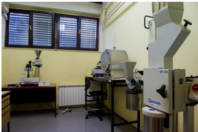
Slika 9. Oprema za pripremu uzoraka čvrstih biogoriva za analizu
