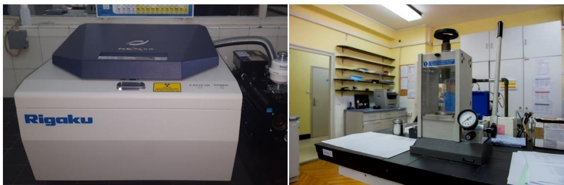
Slika 16. EDXRF spektrometar (lijevo) i preša za tabletiranje uzorka (desno)
