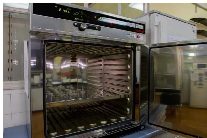
Slika 10. Određivanje vlage analitičkog uzorka
