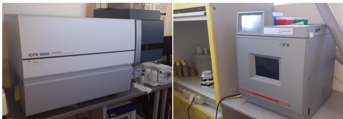
Slika 14. ICP-OES spektrometar (lijevo) i uređaj za mikrovalnu digestiju (desno)
