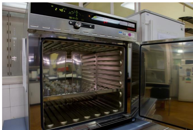
Slika 10. Određivanje vlage analitičkog uzorka
