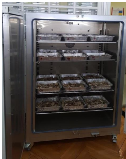
Slika 8. Sušionik za određivanje ukupne vlage drvene sječke
