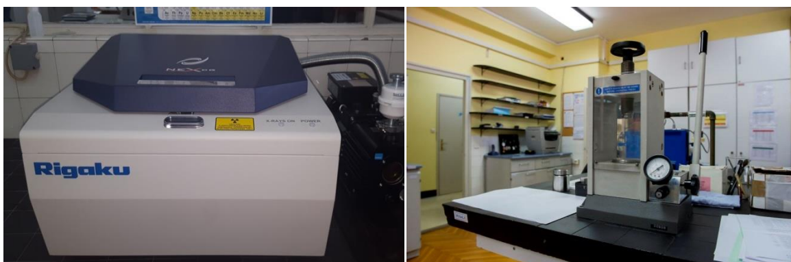
Slika 16. EDXRF spektrometar (lijevo) i preša za tabletiranje uzoraka (desno)
