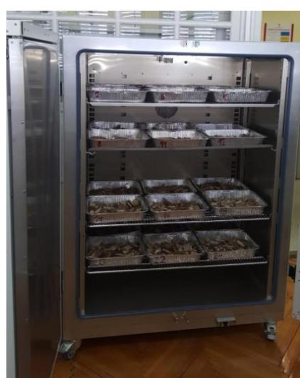
Slika 8. Sušionik za određivanje ukupne vlage drvne sječke
