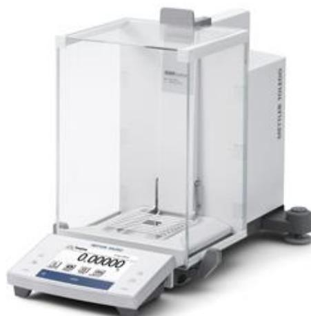
**Slika 9.** Analitička vaga XS204 DeltaRange, Mettler Toledo 15
