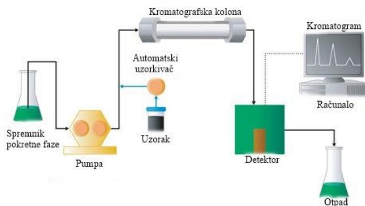
**Slika 4.** Dijelovi HPLC kromatografa [17]
