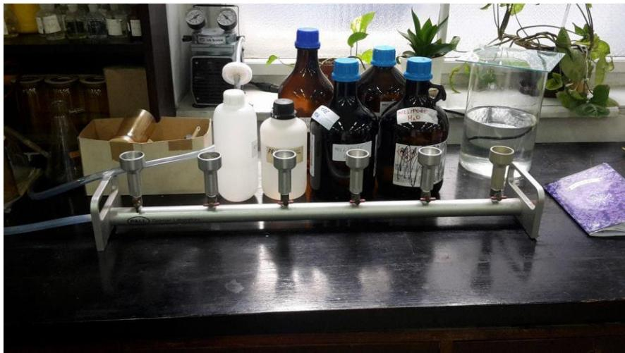
**Slika 8.** Uređaj za filtraciju PALL Life Sciences
