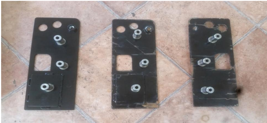
Slika 20.: Uzorak koji nije boravio u slanoj komori (lijevo), uzorci nakon ispitivanja u slanoj komori (u sredini i desno)
