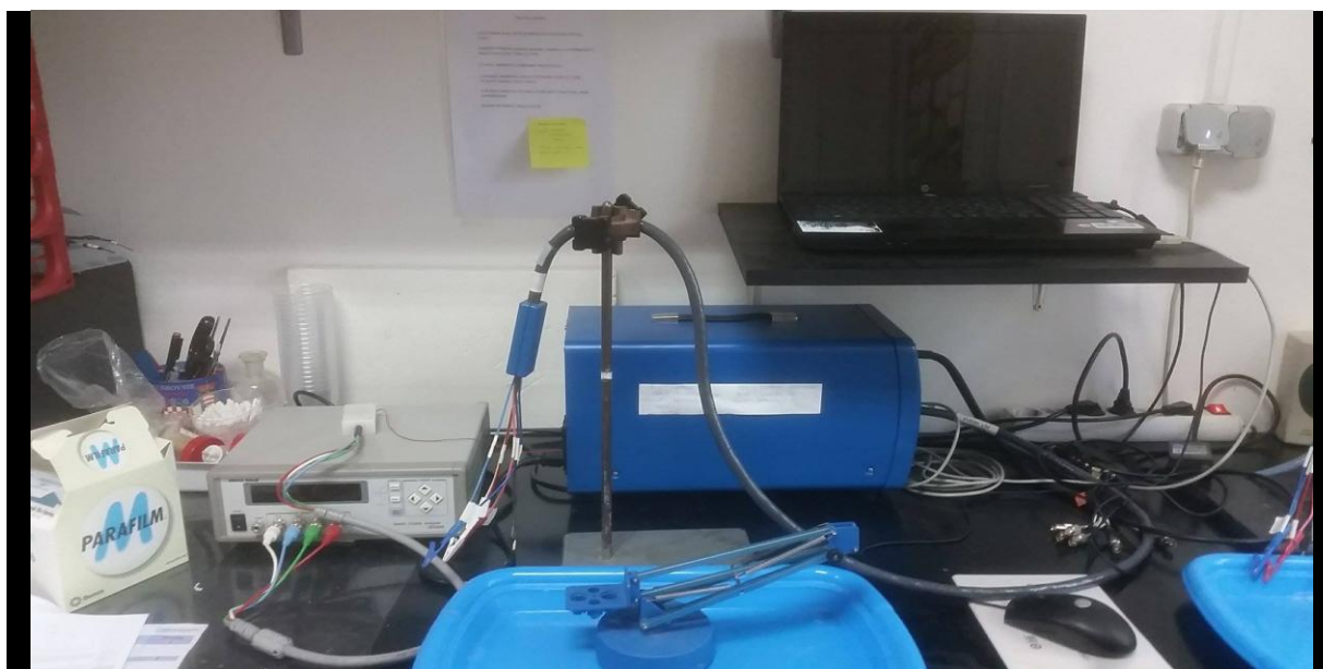
Slika 13.: Aparatura za provođenje korozijskog ispitivanja elektrokemijskom impedancijskom spektroskopijom
