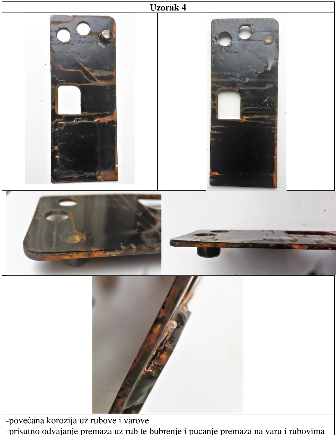
Tablica 9.: Uzorak 4 nakon ispitivanja u slanoj komori
