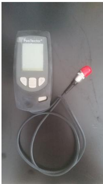
Slika 6.: Uređaj za mjerenje debljine premaza
