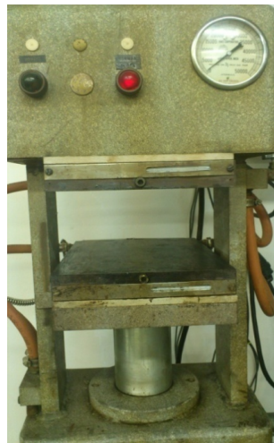
Slika 36. Preša Dake Model 44-226
