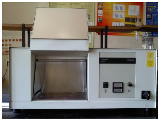
Slika 37. UV komora SUNTEST
