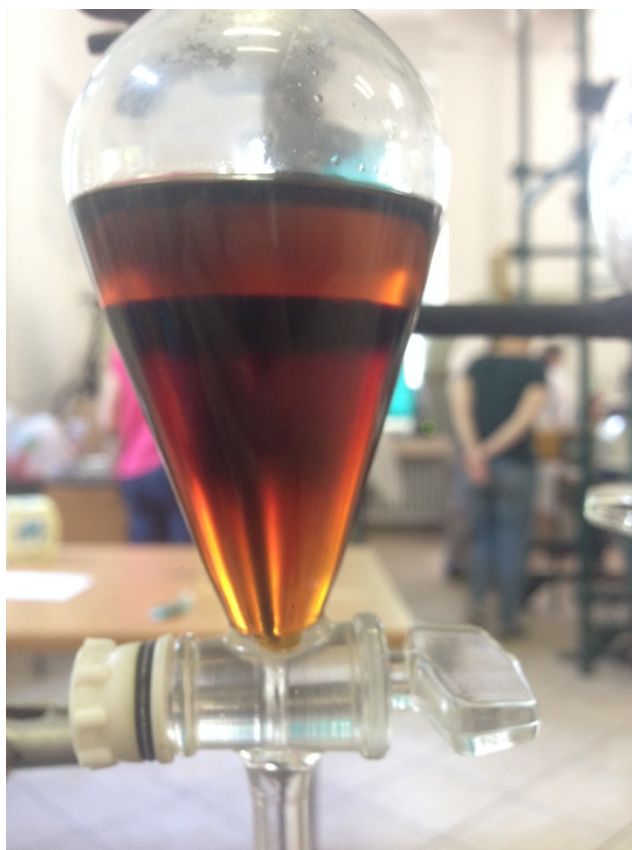
Slika 3.6: Biodizel nakon ekstrakcije, gornji sloj u lijevku je biodizel.
