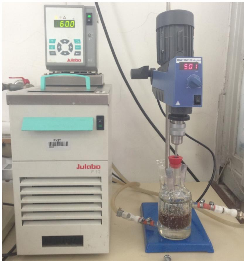
*Slika 3.3: Aparatura za kiselu esterifikaciju*
