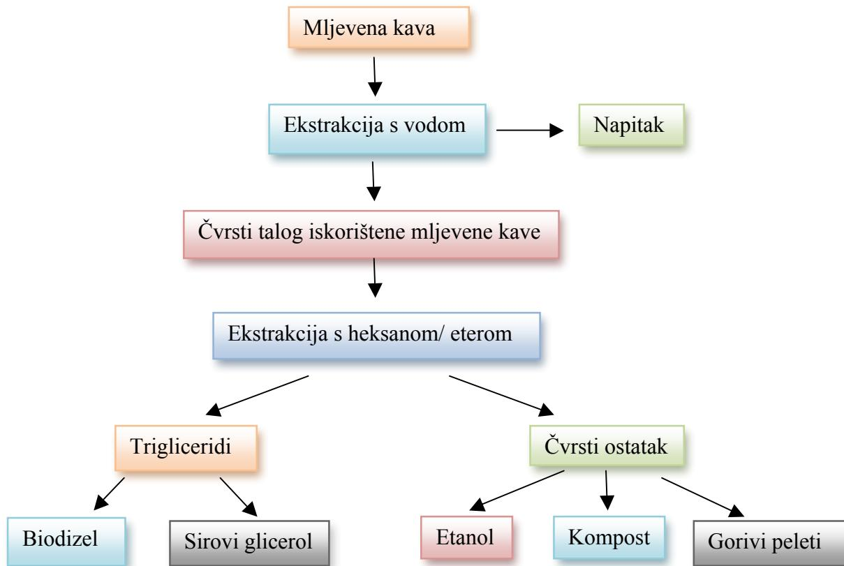
Slika 2.6: Shematski prikaz dobivanja biodizela iz taloga kave<sup>10</sup>
