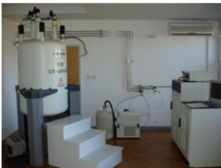
Slika 3.8: ^1\text{H} NMR Spektrometar Bruker Avance 300
