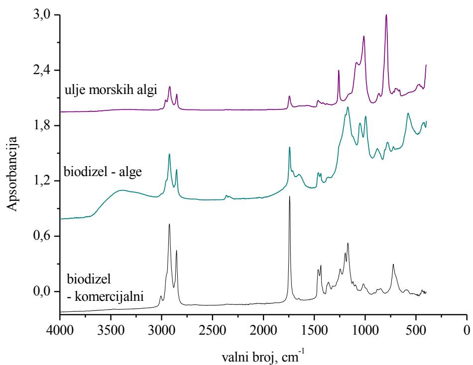
*Slika 4.9: Usporedba FTIR spektara ulja morskih algi te biodizela dobivenog iz algi u odnosu na komercijalni biodizel*
