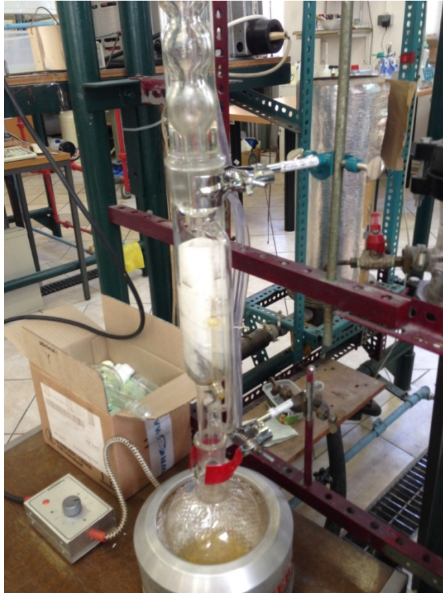
Slika 3.1: Aparatura za ekstrakciju ulja iz kave
