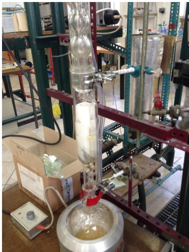
Slika 3.1: Aparatura za ekstrakciju ulja iz kave
