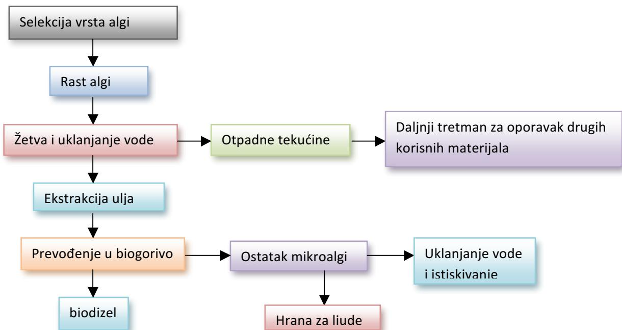
Slika 2.11: Shematski prikaz dobivanja biodizela iz algi<sup>12</sup>
