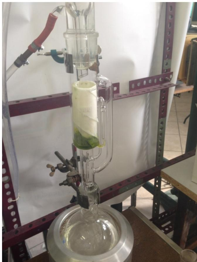
Slika 3.15: Soxhlet aparatura
