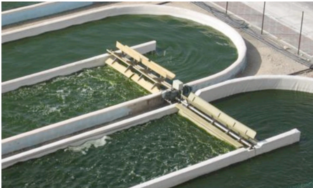
Slika 2.8: Princip otvorenog sustava proizvodnje algi 14
