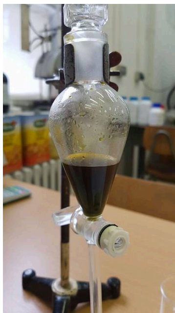
Slika 3.16: Dobiveni biodizel i glicerol procesom transesterifikacije
