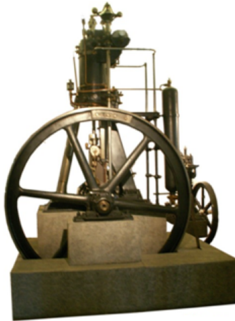
Slika 2.4: Dieselov motor pogonjen na ulje kikirikija
