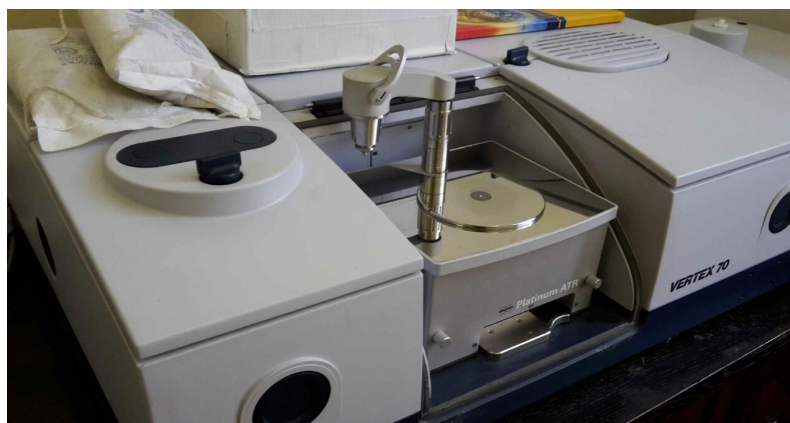
Slika 3.7: Uređaj za FTIR analizu- Bruker Vertex 70
