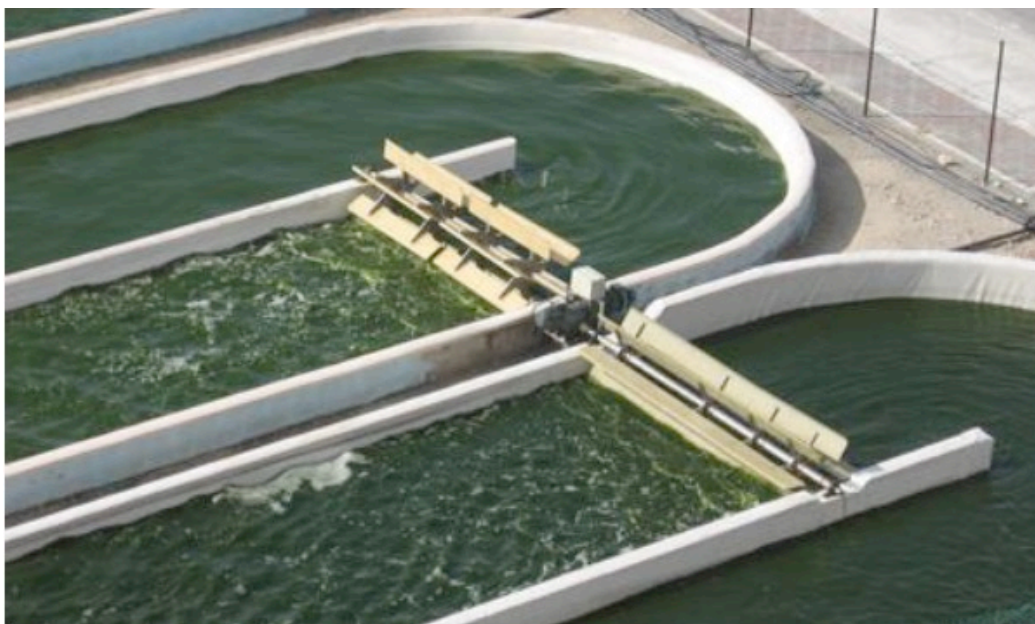
Slika 2.8: Princip otvorenog sustava proizvodnje algi 14
