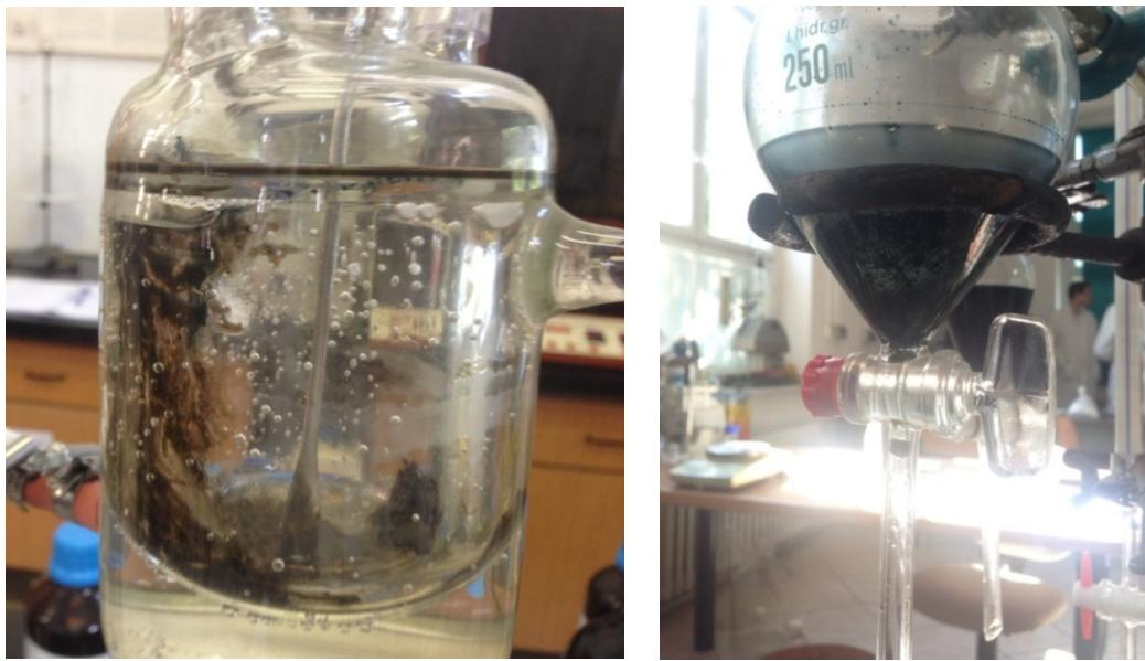
Slika 4.2: Zelenkast talog nastao kiselom esterifikacijom
