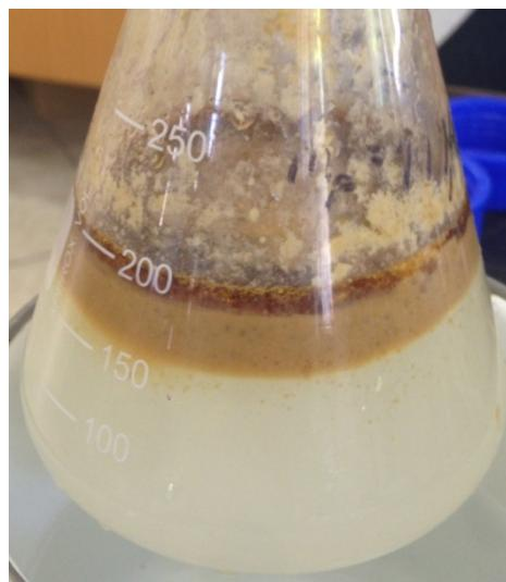
*Slika 4.1: Emulzija nastala ispiranjem ekstrahiranog ulja vrućom vodom*
