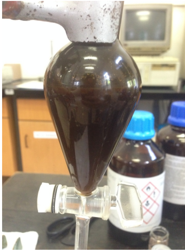
Slika 3.4: Ekstrahirano ulje kave nakon drugog koraka kisele esterifikacije
