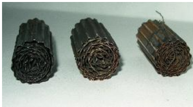
Slika 12. Metalni monolitni katalizatori
