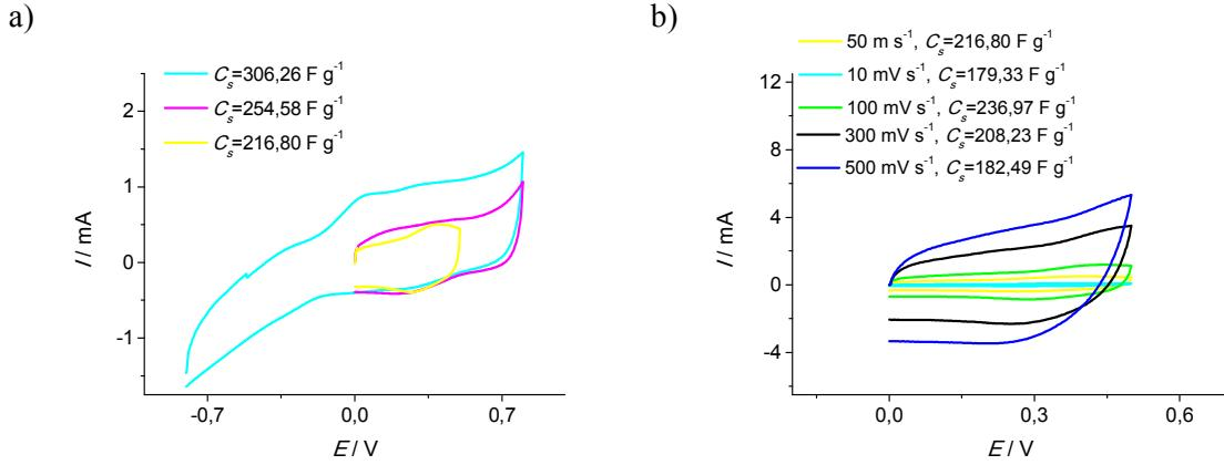
**Slika 4.1.** Ciklički voltamogrami zabilježeni za elektrodu rGO11 a) u različitim područjima potencijala pri brzini promjene potencijala od  $50 \text{ mV s}^{-1}$  te uz b) razne brzine promjene potencijala
