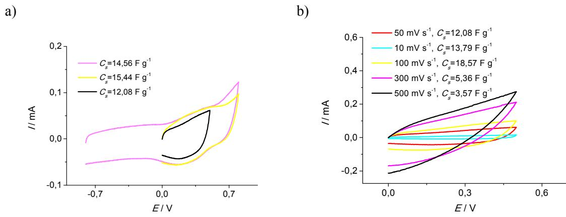
**Slika 4.6.** Ciklički voltamogrami zabilježeni za elektrodu rGO31 a) u različitim područjima potencijala pri brzini promjene potencijala od  $50 \text{ mV s}^{-1}$  te uz b) razne brzine promjene potencijala
