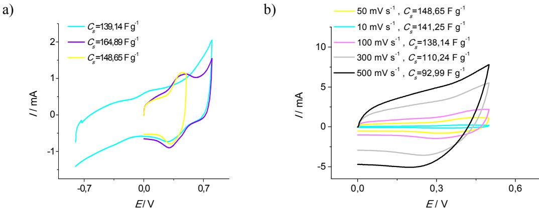
**Slika 4.2.** Ciklički voltamogrami zabilježeni za elektrodu rGO12 a) u različitim područjima potencijala pri brzini promjene potencijala od  $50 \text{ mV s}^{-1}$  te uz b) razne brzine promjene potencijala
