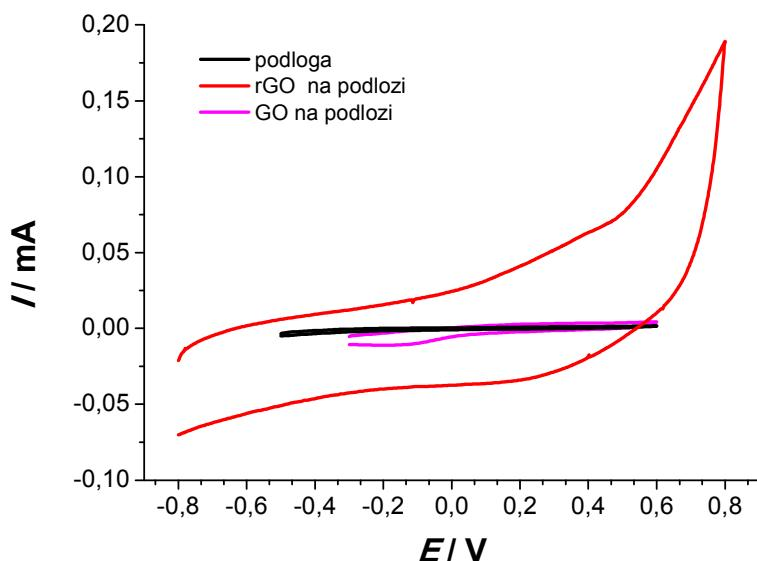
**Slika 5.1.** Ciklički voltamogram zabilježen za GO i rGO na podlozi, te za čistu podlogu u  $0,5 \text{ mol dm}^{-3}$  otopini  $\text{Na}_2\text{SO}_4$
