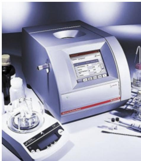
**Slika 3.1.** Prikaz Anton Paar Monowave 300 mikrovalnog reaktora
