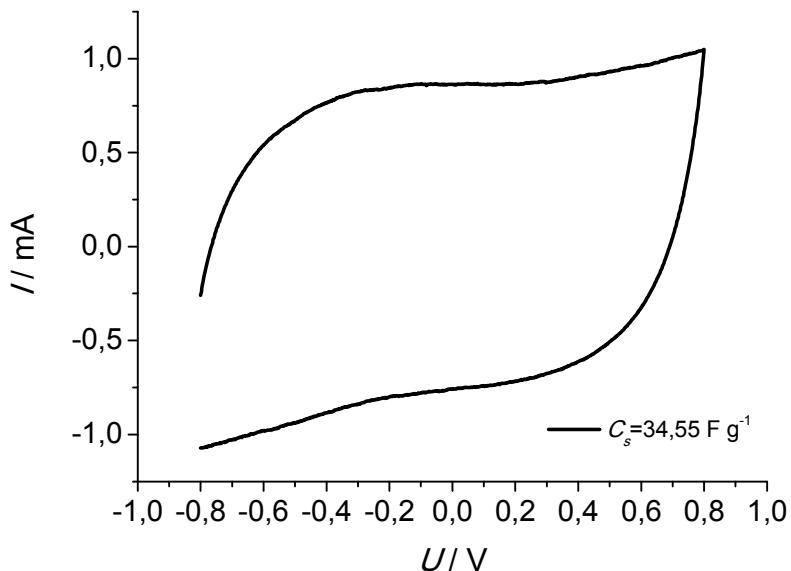
**Slika 4.7.** Ciklički voltamogram zabilježen za superkondenzator u širokom području potencijala pri brzini promjene potencijala od  $50 \text{ mV s}^{-1}$
