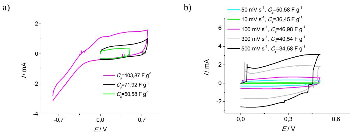
**Slika 4.3.** Ciklički voltamografi zabilježeni za elektrodu rGO13 a) u različitim područjima potencijala pri brzini promjene potencijala od  $50 \text{ mV s}^{-1}$  te uz b) razne brzine promjene potencijala
