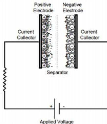
**Slika 2.14.** Shema superkondenzatora [23]
