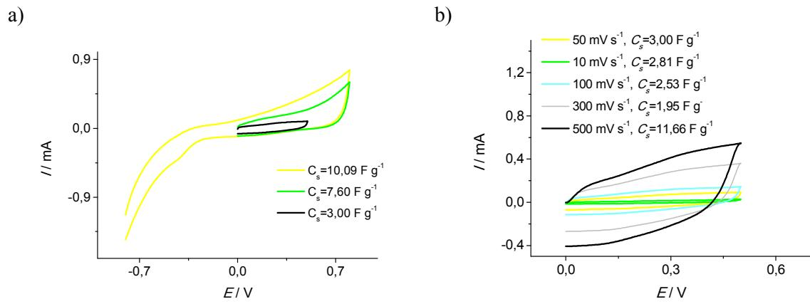
**Slika 4.4.** Ciklički voltamogrami zabilježeni za elektrodu rGO14 a) u različitim područjima potencijala pri brzini promjene potencijala od  $50 \text{ mV s}^{-1}$  te uz b) razne brzine promjene potencijala
