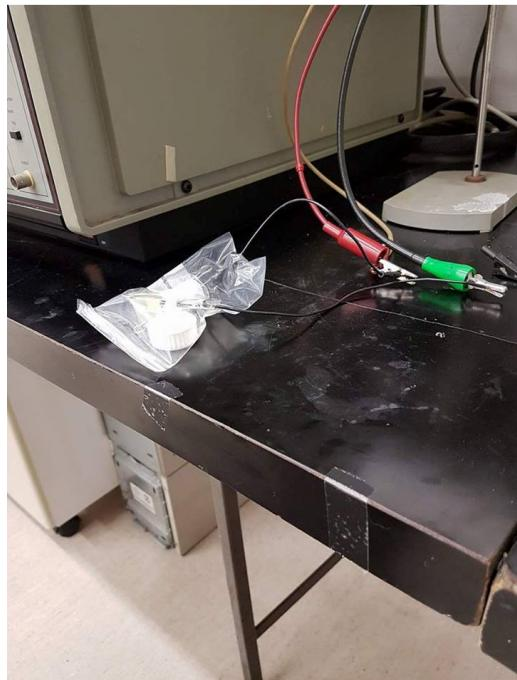
**Slika 3.6.** Superkondenzator u vrećici sa hermetičkim zatvaračem u kojoj se nalazi i posuda s vodom koja osigurava vlažnu atmosferu i sprječava gubitak elektrolita
