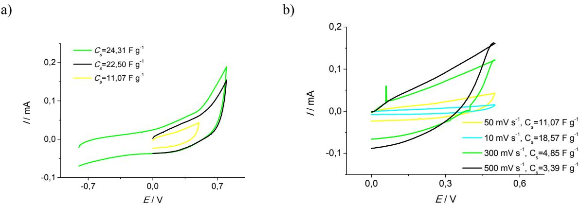
**Slika 4.5.** Ciklički voltamogrami zabilježeni za elektrodu rGO21 a) u različitim područjima potencijala pri brzini promjene potencijala od  $50 \text{ mV s}^{-1}$  te uz b) razne brzine promjene potencijala
