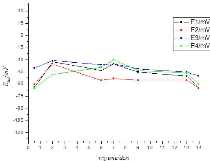
**Slika 4-8:** Ovisnost koroziskog potencijala o vremenu za leguru Cu-Ni pri temperaturi od 60°C
