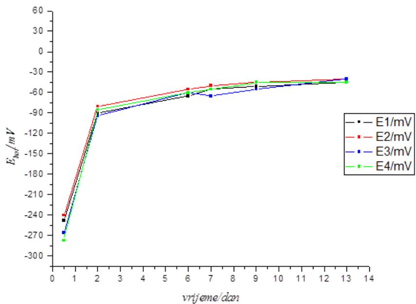
**Slika 4-2:** Ovisnost koroziskog potencijala o vremenu za leguru Cr-Ni pri temperaturi od 30°C
