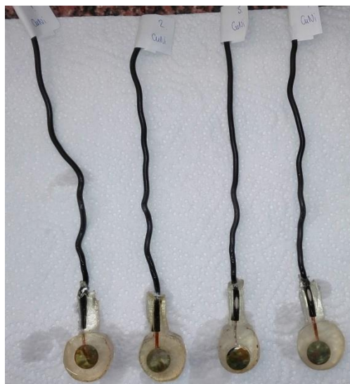
Slika 3-2: Uzorci bakar- nikal legure izvedeni kao elektrode
