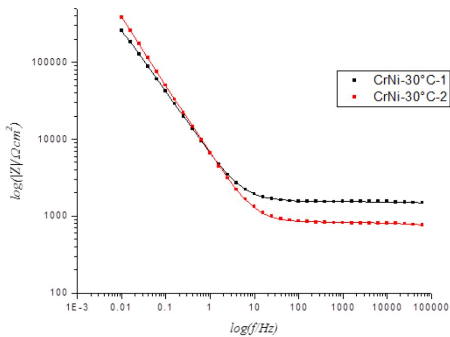
**Slika 4-16:** Ovisnost faznog kuta i logaritma apsolutne vrijednosti impedancije o logaritmu frekvencije za leguru Cr- Ni pri  $30^\circ\text{C}$ ; točakama su prikazane izmjerene vrijednosti, a linijama vrijednosti izračunate prema modelu.
