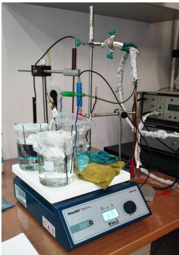
Slika 3-3: Aparatura za mjerenje korozivnog potencijala pri zadanoj temperaturi (lijevo) te prikaz ispitivanog sustava (desno)
