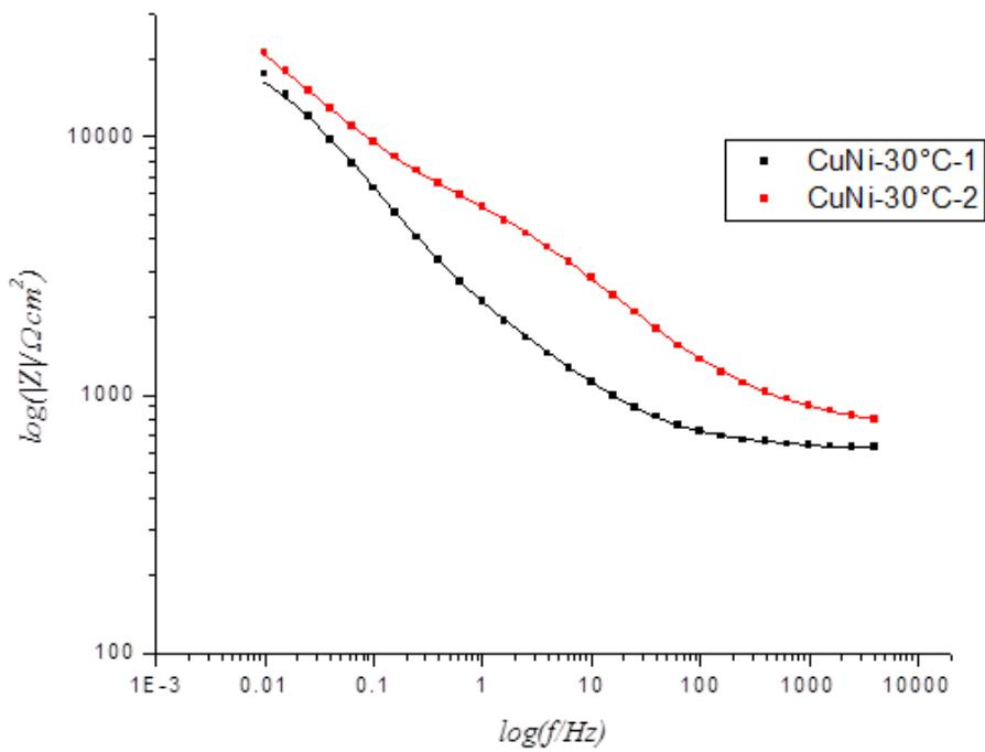
**Slika 4-20:** Ovisnost faznog kuta i logaritma apsolutne vrijednosti impedancije o logaritmu frekvencije za leguru Cu- Ni pri 30°C; točakama su prikazane izmjerene vrijednosti, a linijama vrijednosti izračunate prema modelu.
