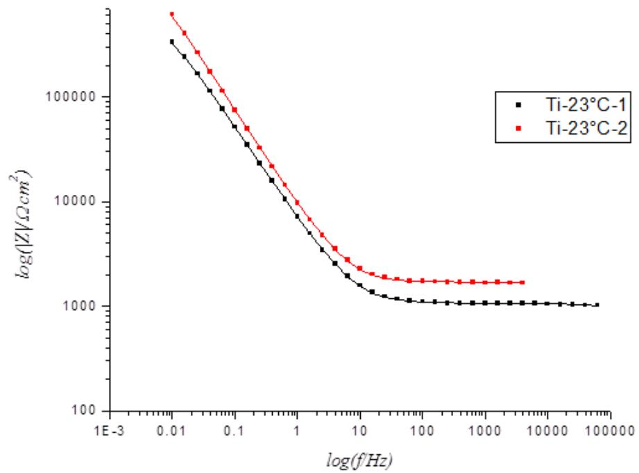
**Slika 4-22:** Ovisnost faznog kuta i logaritma absolutne vrijednosti impedancije o logaritmu frekvencije za uzorak titana pri 23°C; točakama su prikazane izmjerene vrijednosti, a linijama vrijednosti izračunate prema modelu.
