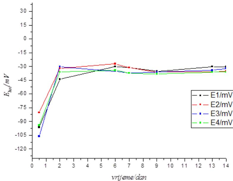
**Slika 4-7:** Ovisnost koroziskog potencijala o vremenu za leguru Cu-Ni pri temperaturi od 50°C
