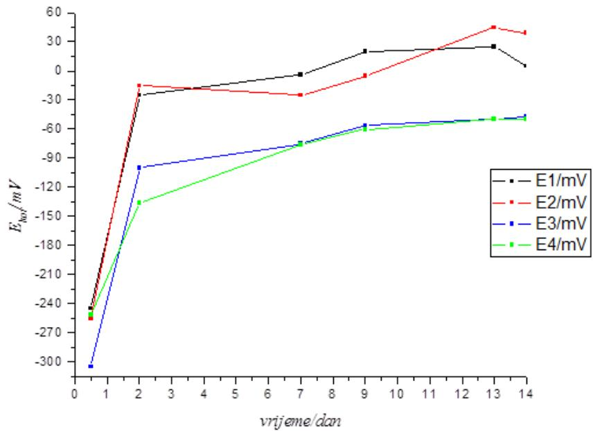
**Slika 4-1:** Ovisnost koroziskog potencijala o vremenu za leguru Cr-Ni pri temperaturi od 23°C
