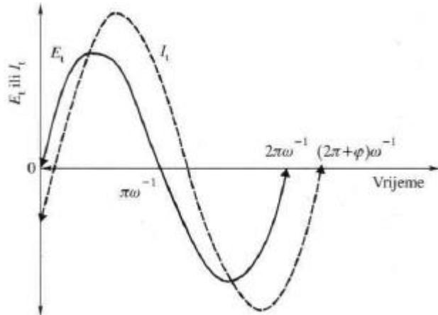
**Slika 3-5:** Sinusoidalni val za pobudni potencijal ( $E$ ) i odzivnu struju ( $I$ ) [4]
