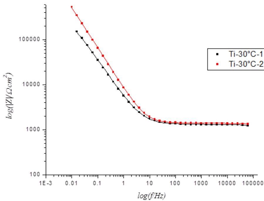
**Slika 4-23:** Ovisnost faznog kuta i logaritma apsolutne vrijednosti impedancije o logaritmu frekvencije za uzorak titana pri  $30^\circ\text{C}$ ; točakama su prikazane izmjerene vrijednosti, a linijama vrijednosti izračunate prema modelu.
