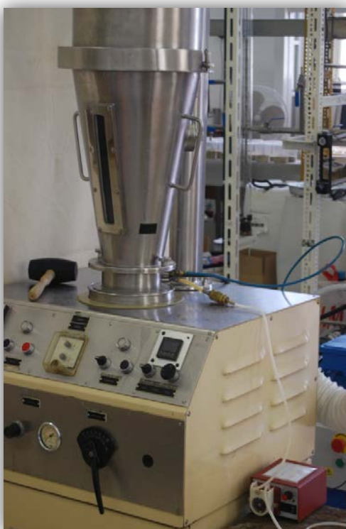
Slika 2.3. Fotografija granulatora s fluidiziranim slojem Uni-Glatt (Glatt GmbH, Binzen, Savezna Republika Njemačka).
