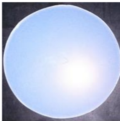
Slika 4. Imobiliziran film P25 na staklenoj pločici.
