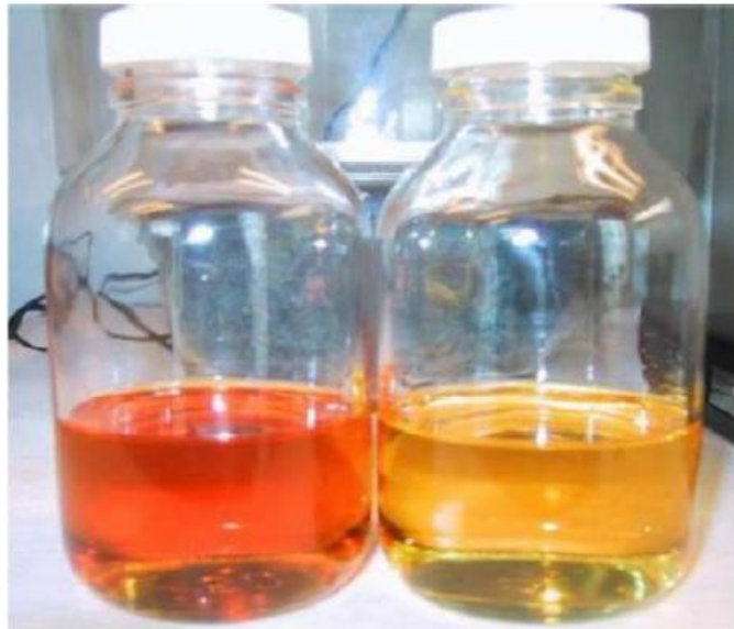
Slika 9. Staro i novo transformatorsko ulje
