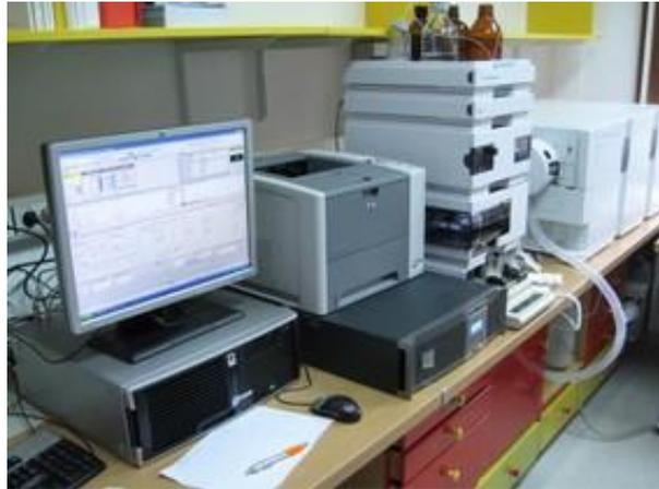
**Slika 9.** Tekućinski kromatograf UHPLC (Agilent Series 1290) sa spektrometrom masa
