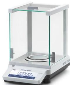
**Slika 5.** Analitička vaga Mettler Toledo
