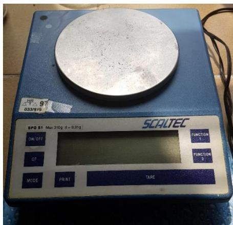
**Slika 6.** Tehnička vaga Scaltec SP0 51
