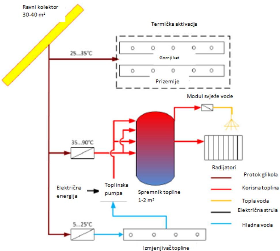
Slika 6: Shema sustava solarnog termalnog grijanja [9]
