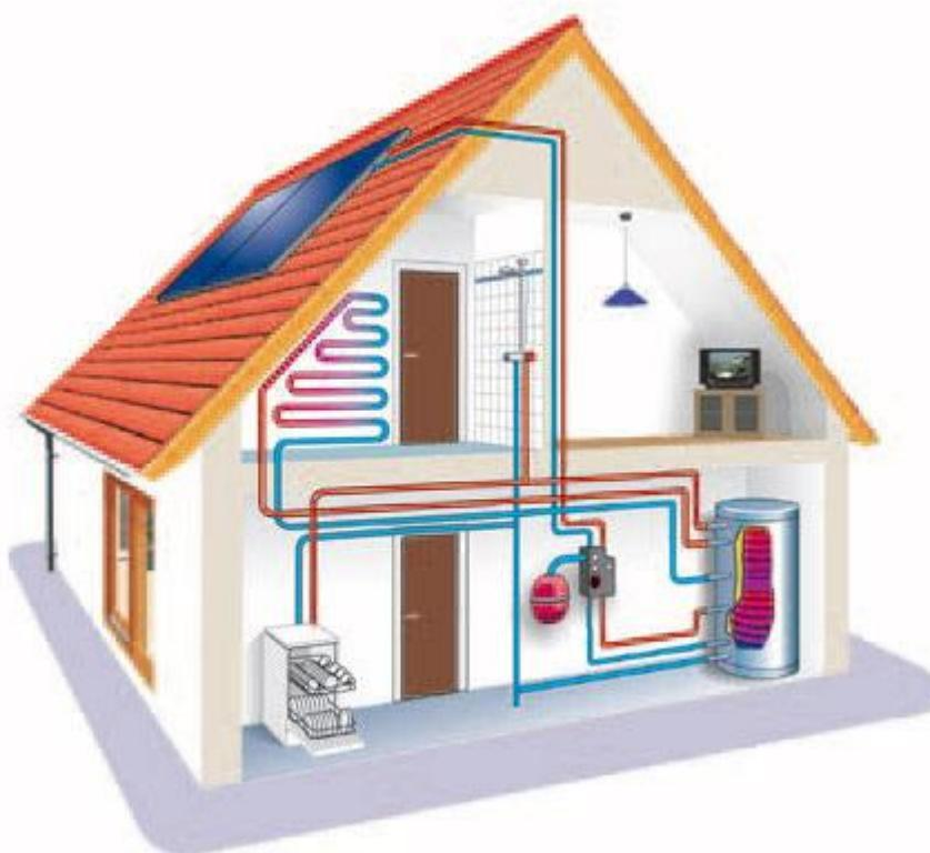
Slika 10 : Solarni sustav od dva kolektora [13]
