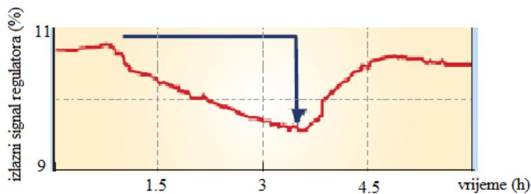
**Slika 33.** Promjena izlaznog signala (OP) regulatora razine<sup>[24]</sup>
