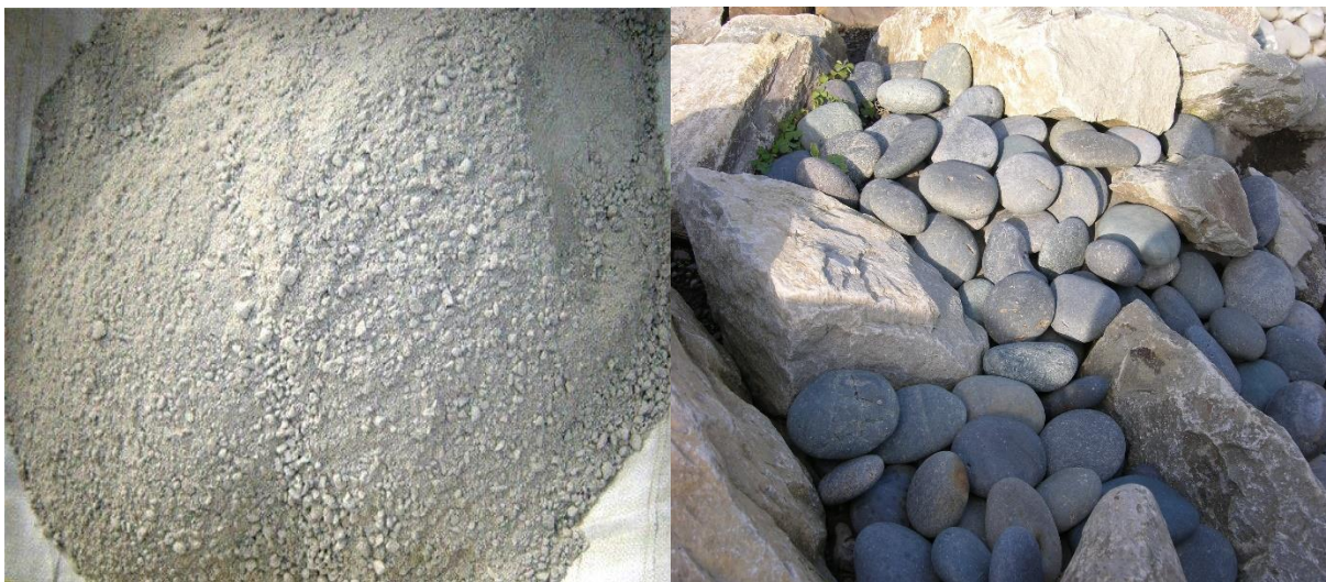
Slika 2. Usporedba mljevenog portland cementa i kamena iz Portlanda.
