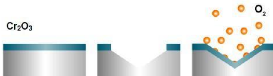
Slika 2. Prikaz samoobnavljanja pasivnog filma kromovih oksida na površini nehrđajućeg čelika [5]
