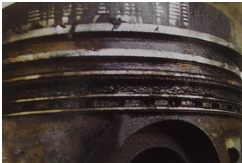
Slika 3. Izgled klipa motora nakon uporabe biljnog ulja 1
