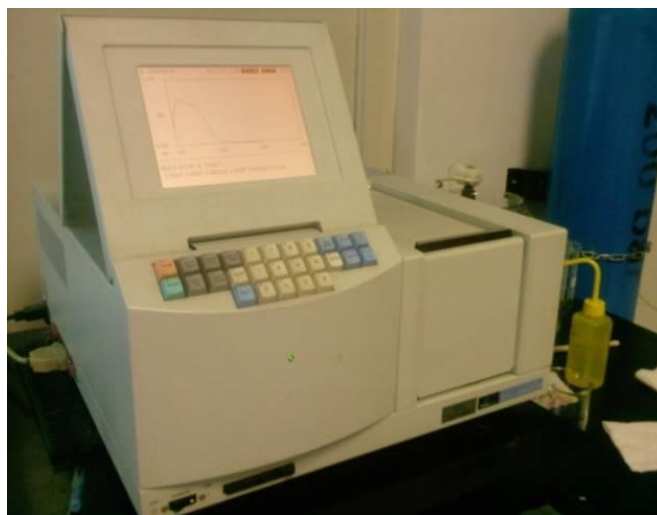
Slika 3.4. UV/Vis spektrofotometar Perkin Elmer Lambda EZ 201
