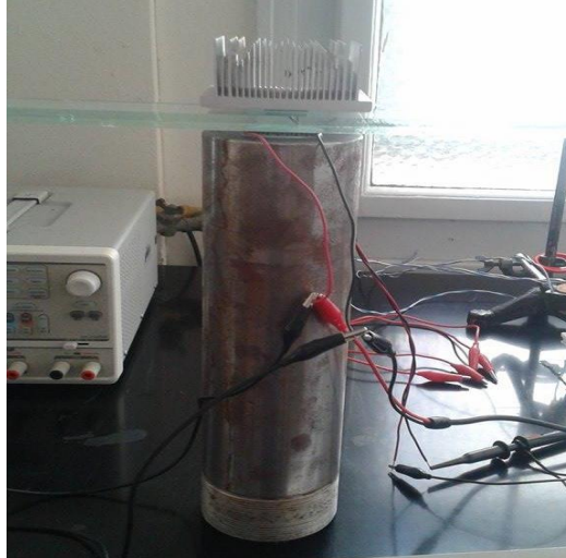
Slika 9. Željezni valjak korišten kao ponor topline u mjerenju
