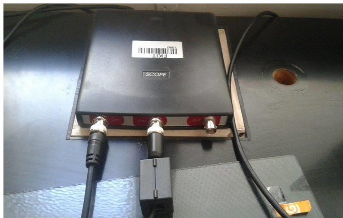
Slika 10. Handyscope korišten u ispitivanjima
