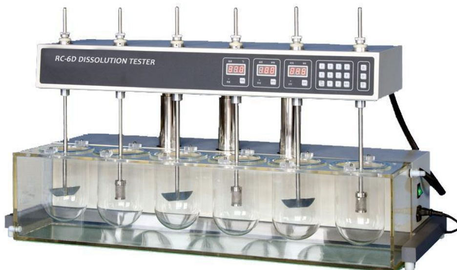
Slika 7. Uređaj za ispitivanje otpuštanja djelatnih tvari (RC-6D, Zhengzhou Nanbei Instrument)
