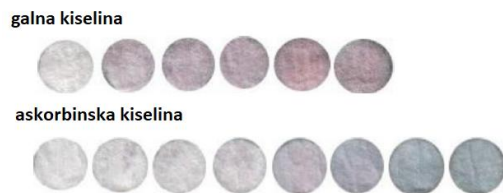
Slika 24. Rezultat kolorimetrijskog senzora baziranog na papiru. 62
