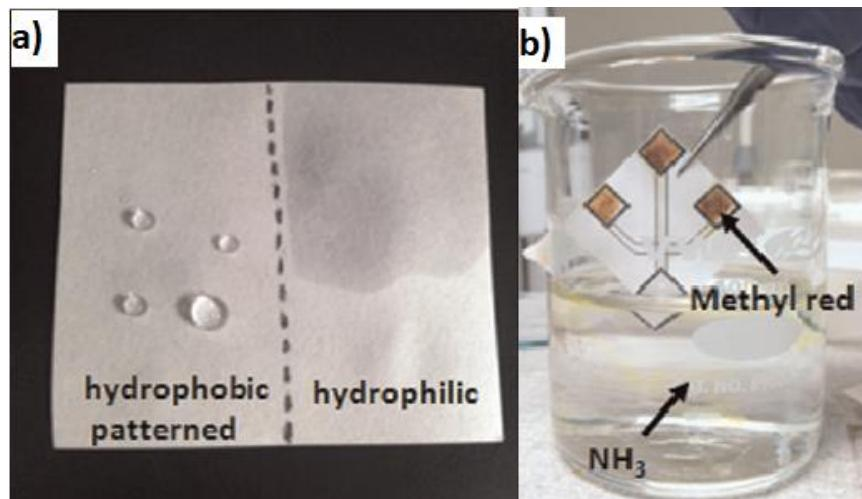
**Slika 23.** a) Test hidrofobnosti na papiru koji je tretiran hidrofobnim raspršivanjem; b) uzorak uređaja uronjen u otopinu amonijaka.<sup>65</sup>
