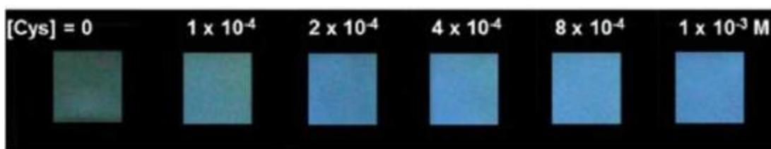
**Slika 26.** Promjena u intenzitetu fluorescencije na papiru s obzirom na koncentraciju cisteina (snimljeno na 430 nm)<sup>64</sup>
