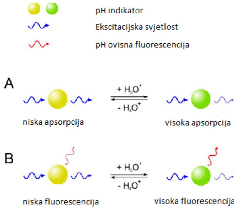
**Slika 4.** Shematski prikaz principa rada pH senzora temeljeni na apsorpcijskom (A) i temeljeni na fluorescencijskom pH osjetljivom mehanizmu (B).<sup>7</sup>
