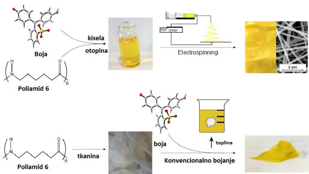
**Slika 14.** Konstruiranje nanovlakana i proces immobilizacije primjenom električnog polja.<sup>46</sup>
