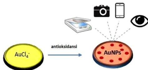
**Slika 25.** Određivanje aktivnosti antioksidansa vrši se senzorom baziranim na papiru i imobiliziranim zlatnim nanočesticama.<sup>62</sup>
