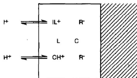
**Slika 6.** Shematski prikaz relevantnih ravnotežnih faza prijenosa za neutralne ionofore. L - lipofilni nosač iona;  $I^+$  - analit ion;  $R^-$  - zarobljena anionska mjesta; C - kromionofor.<sup>9</sup>
