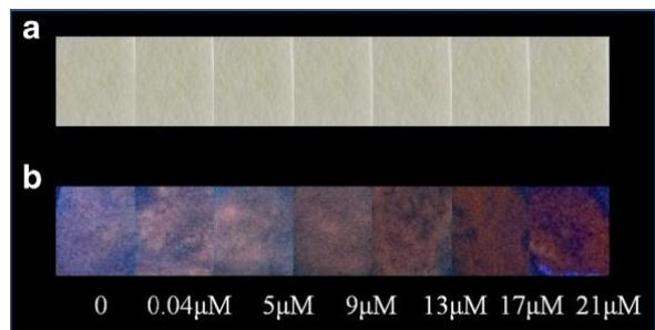
**Slika 20.** Vizualna detekcija Hg(II) pri različitim koncentracijama na filter papiru na a) dnevnoj svjetlosti i b) ispod UV lampe (365 nm)<sup>66</sup>
