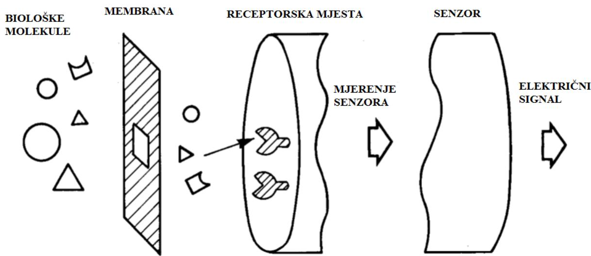
**Slika 2.** Princip rada biokemijskih senzora.
