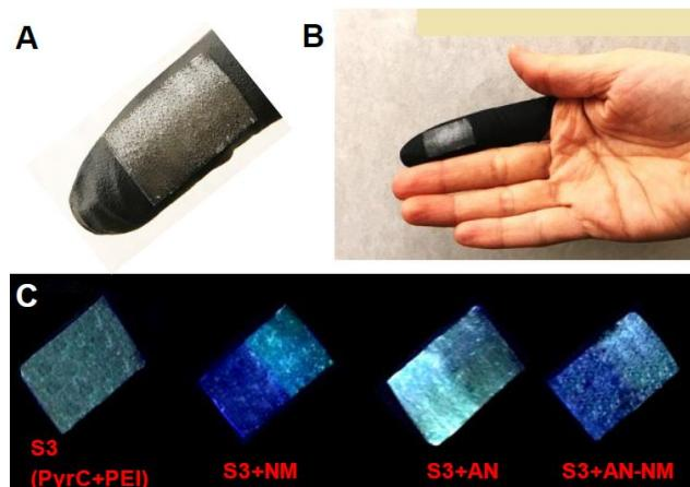
**Slika 18.** Nosivi nanovlknasti senzor. A+B: nanovlknasti dio nanesen na prst nitrilne rukavice. C: prenosivi senzor pokazuje velike promjene u boji u prisutnosti nitrometana, kao i u prisutnosti amonijevog nitrata i ANNM.<sup>53</sup> (S3 – 1-pirenkarboskialdehid (PyrC) i polietilen imin (PEI))
