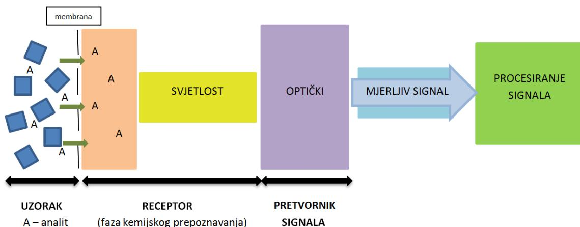
**Slika 5.** Shematski prikaz principa rada optičkog kemijskog senzora.<sup>3</sup>
