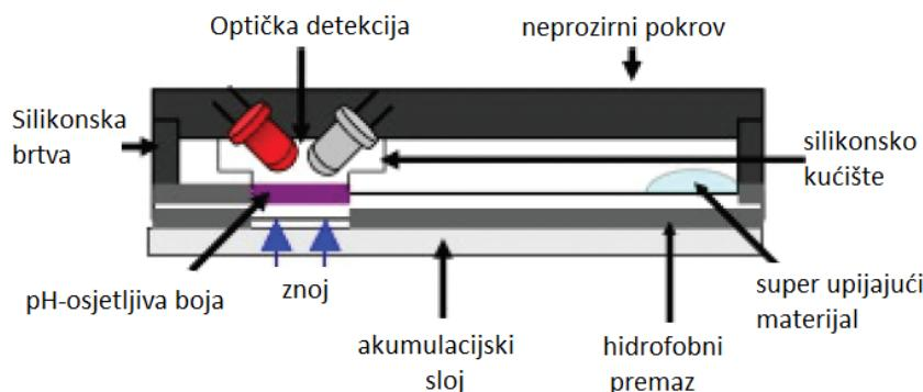
**Slika 15.** Ilustracija pH senzora na tekstuilu i sustava optičke detekcije na zavodu za praćenje pH znoja.<sup>29</sup>
