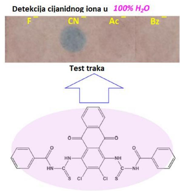
**Slika 27.** Detekcija cijanidnog iona uz pomoć test traka baziranih na papiru.<sup>67</sup>
