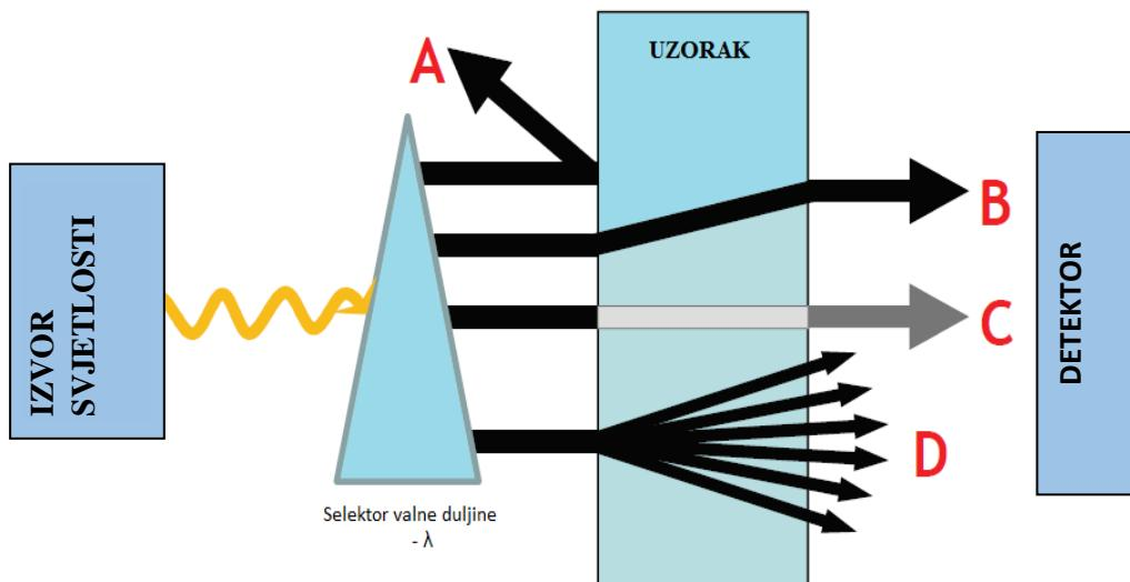
**Slika 3.** Shematski prikaz spektrokemijskih mjerena: A – refleksija svjetla, B – refrakcija svjetla, C – apsorpcija svjetla, D – emisija svjetla<sup>1</sup>
