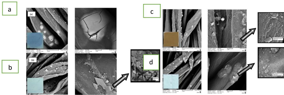
**Slika 19.** a) Pamuk/ $\text{Cu}_2\text{O}$  mješavina izložena amonijaku, b) nakon redukcije sa octenom kiselinom, c) Pamuk/ $\text{Cu}_2\text{O}$  mješavina izložena vodikovom peroksidu, d) nakon redukcije sa octenom kiselinom.<sup>54</sup>
