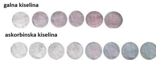
**Slika 24.** Rezultat kolorimetrijskog senzora baziranog na papiru.<sup>62</sup>
