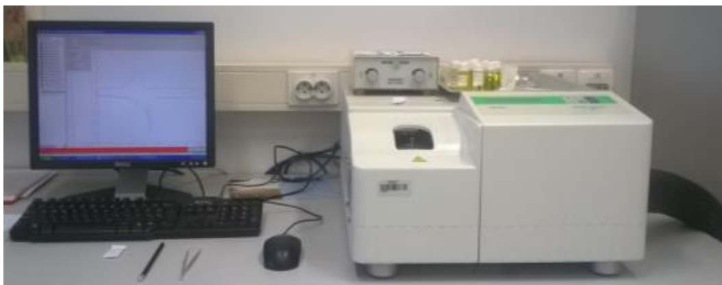
Slika 17. DSC uređaj Mettler Toledo DSC 822e povezan s računalom
