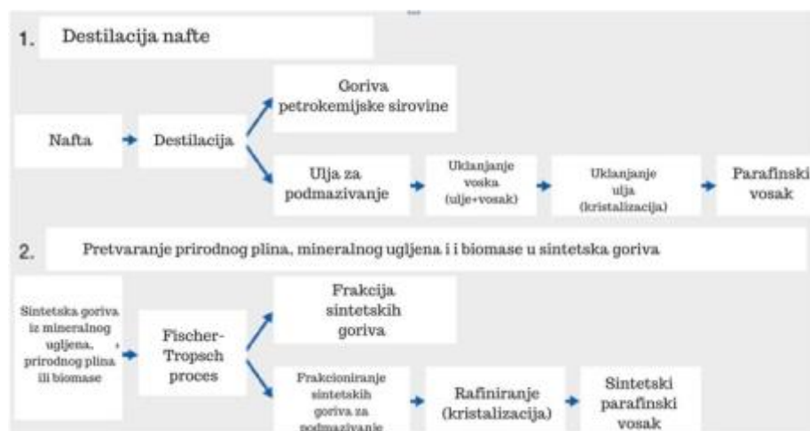
Slika 12. Shema dobivanja parafinskog voska [8]
