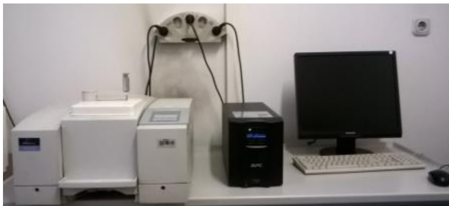
Slika 14. Perkin Elmer Spectrum One Spectrometer FTIR-ATR povezan s računalom
