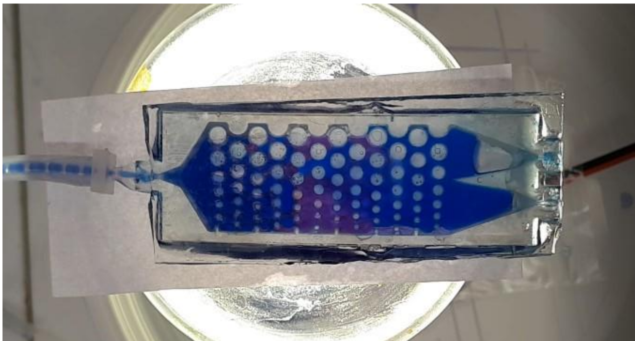
Slika 35. Separator v6.0-2 vodena faza na oba izlaza
