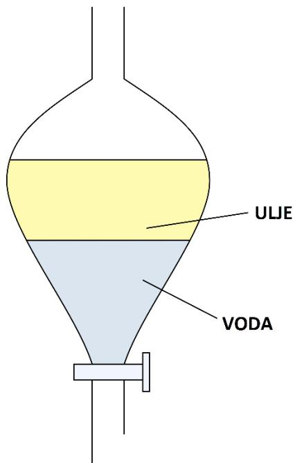
Slika 2. Lijevak za ekstrakciju
