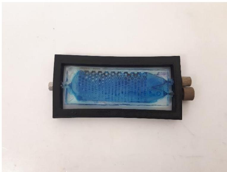
Slika 20. Izvijeni separator i okvir
