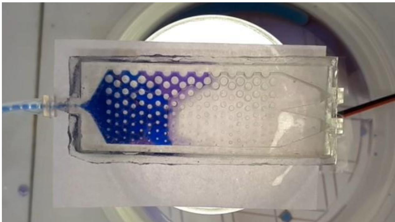
Slika 30. Separator v5.0-3 početak strujanja
