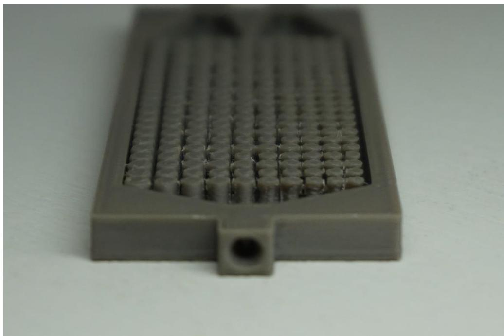
Slika 10. Spojeni stupovi
