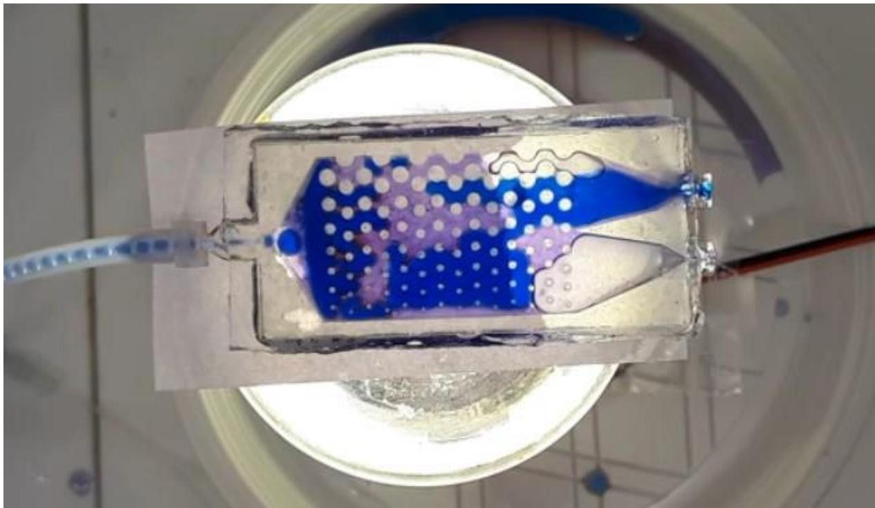
Slika 26. Separator v4.0-3 destabilizacija toka i inverzija
