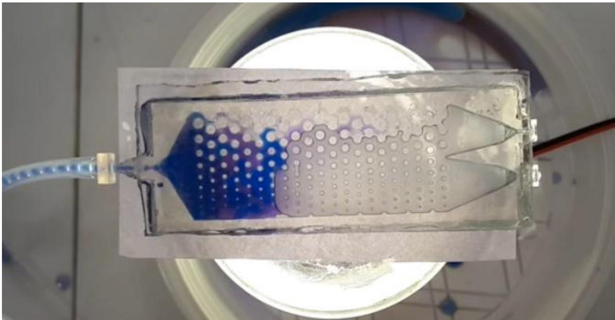
Slika 27. Separator v5.0-1 razvijanje toka kapljivina
