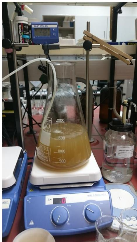
Slika 3.1. Postavljeni Zahn-Wellenov test biorazgradnje.
