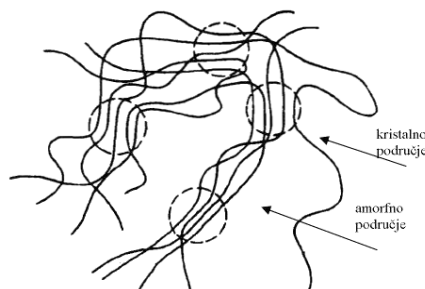
Slika 8. Model kristalastog polimera prema teoriji resastih micela 5
