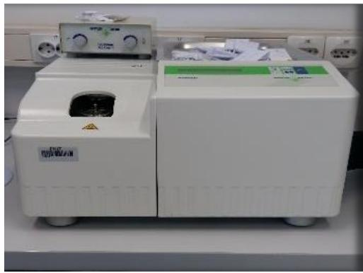
**Slika 33.** DSC uređaj Mettler Toledo DSC 823e
