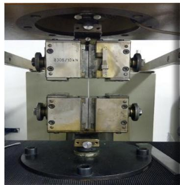
**Slika 36.** Epruveta polistirena između čeljusti Zwick kidalice 1445
