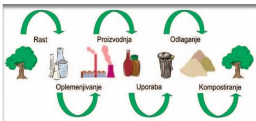
Slika 10. Tijek životnog ciklusa biorazgradljivog polimernog materijala 9
