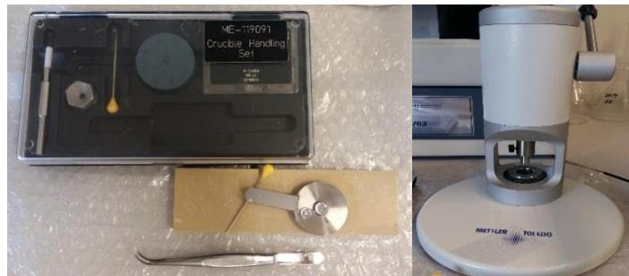
**Slika 34.** Nosač Al posudice i preša za pripravu uzorka za DSC mjerena
