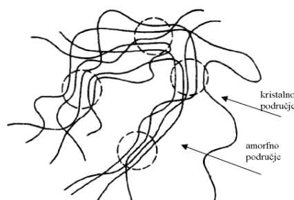
Slika 8. Model kristalastog polimera prema teoriji resastih micela 5
