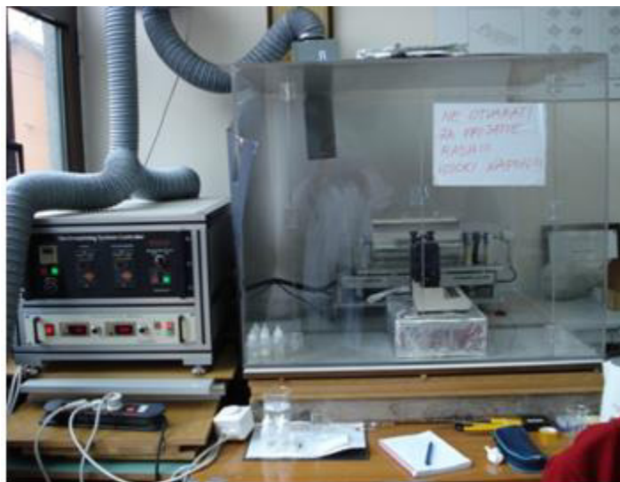
Slika 10. Uređaj za elektroispredanje na Tekstilno-tehnološkom fakultetu u Zagrebu.
