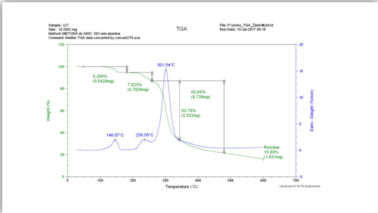
**Slika 4.4.** Prikaz TG/DTG krivulja za azitromicin dihidrat (AZT); uzorak čiste komponente.
