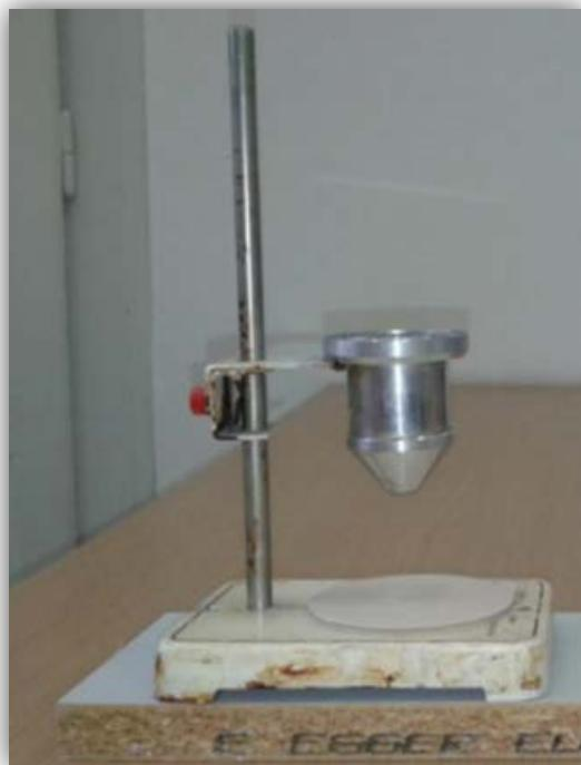
**Slika 3.4.** Fotografija lijevka za određivanje kuta mirovanja
