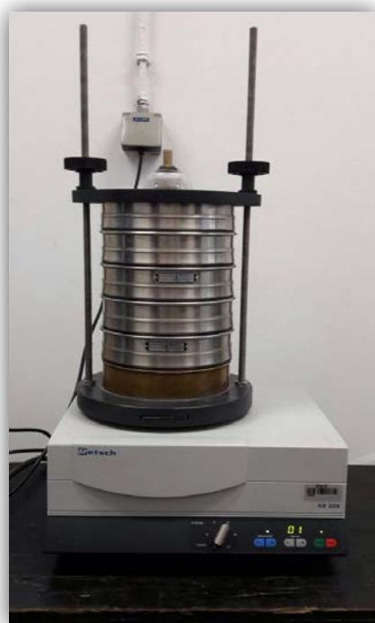
**Slika 3.3.** Fotografija uređaja za potresivanje sita AS 200
