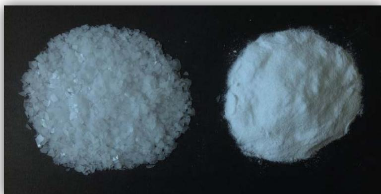
**Slika 3.7.** Usporedni prikaz inicijalnog (lijevo) i usitnjenog (desno) polietilen glikola.
