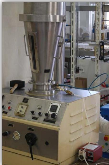
**Slika 3.1.** Fotografija granulatora s fluidiziranim slojem
