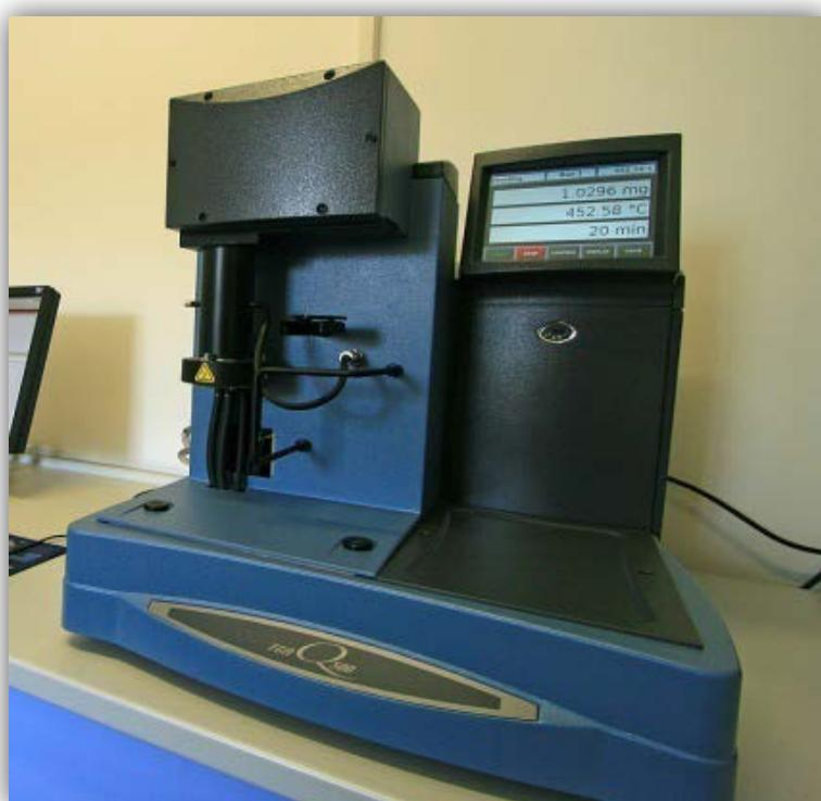
**Slika 3.8.** Fotografija uređaja za termogravimetrijsku analizu Q500 (TA Instruments, New Castle, SAD).
