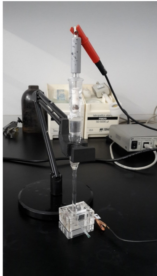
Slika 14. Neprotočna ćelija za potenciometrijsko mjerenje.
