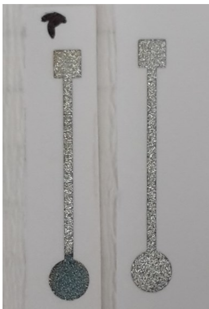
Slika 30. Usporedba elektroda: elektrode su printane na plastičnoj podlozi ink-jet tehnikom; elektroda P oslojena je elektrokemijskim potenciostatskim postupkom te je vidljiv sloj \text{Ag}_4[\text{Fe}(\text{CN})_6] .
