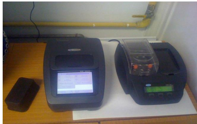
Slika 5. DR 2800 spektrofotometar, Hach Lange (s prijenosnim termoblokom)
