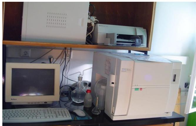
Slika 4. TOC analizator, TOC-V<sub>CPN</sub>, Shimadzu
