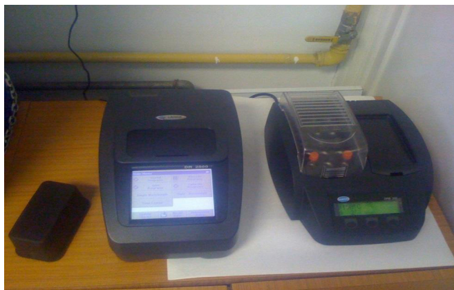
Slika 5. DR 2800 spektrofotometar, Hach Lange (s prijenosnim termoblokom)
