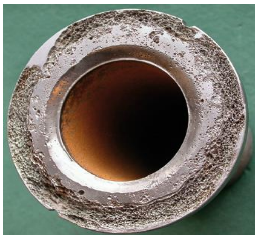
Slika 8. Prikaz korozijskog oštećenja uslijed korozije u zazoru [20] .
